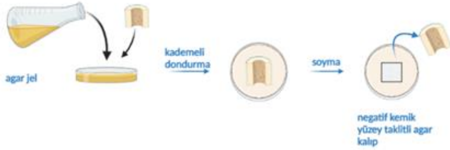
Şekil 4.2 Negatif kemik yüzey taklitli agar kalıp hazırlanması
