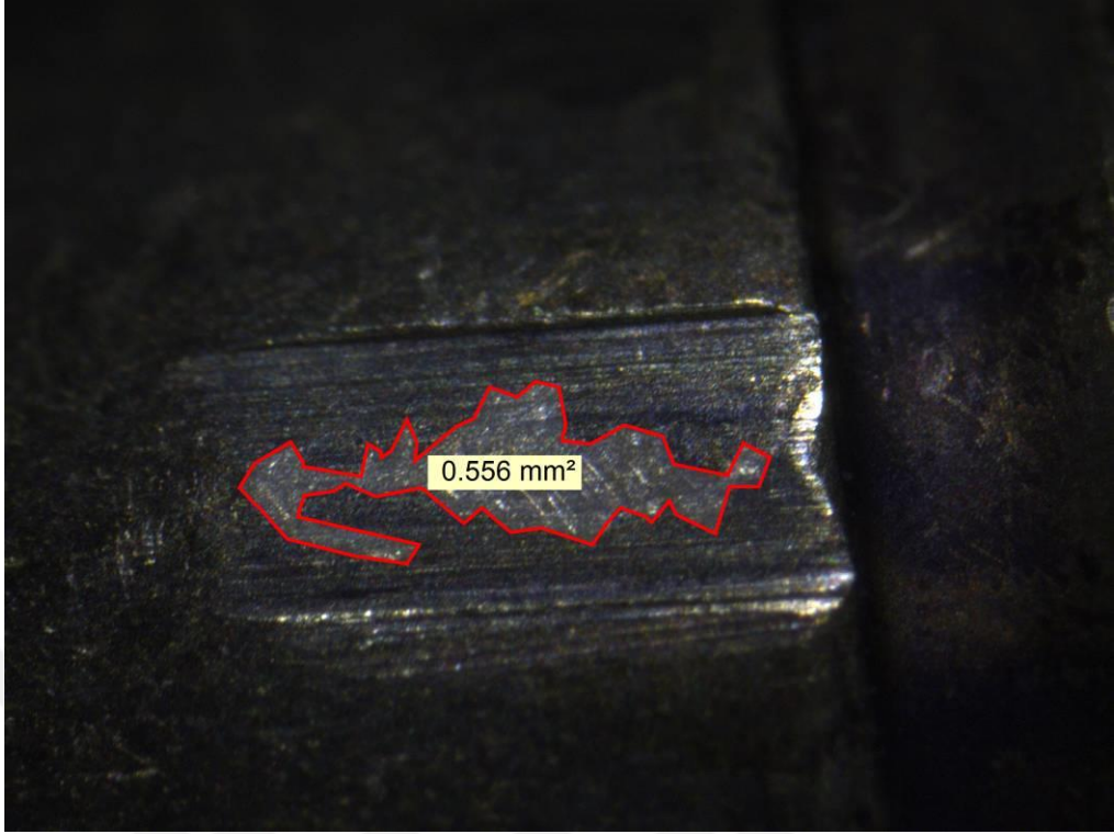
Şekil 3.56. Yirminci Mermi Çekirdeği Üzerinde Oluşan Penset İzi
