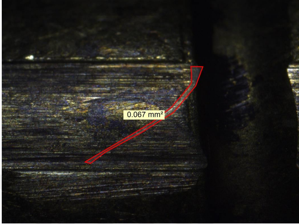
Şekil 3.139. Elli Dördüncü Mermi Çekirdeği Üzerinde Oluşan Penset İzi
