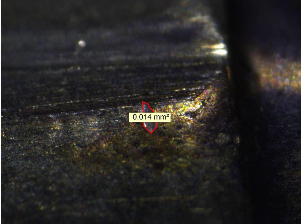
Şekil 3.57. Yirminci Mermi Çekirdeği Üzerinde Oluşan Penset İzi
