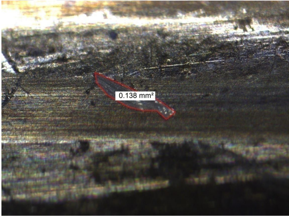
Şekil 3.8. Altıncı Mermi Çekirdeği Üzerinde Oluşan Penset İzi
