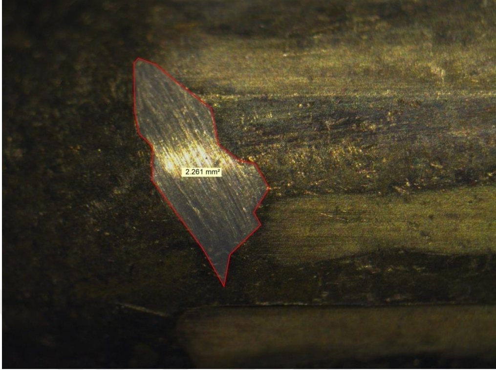
Şekil 3.69. Otuz Birinci Mermi Çekirdeği Üzerinde Oluşan Penset İzi
