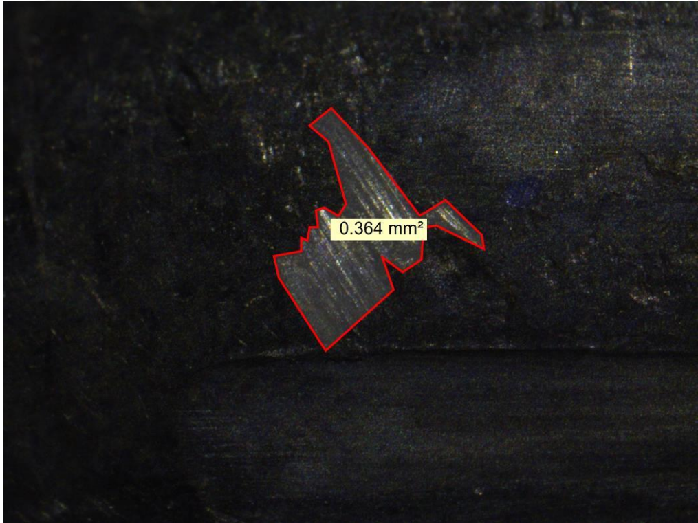
Şekil 3.70. Otuz birinci Mermi Çekirdeği Üzerinde Oluşan Penset İzi
