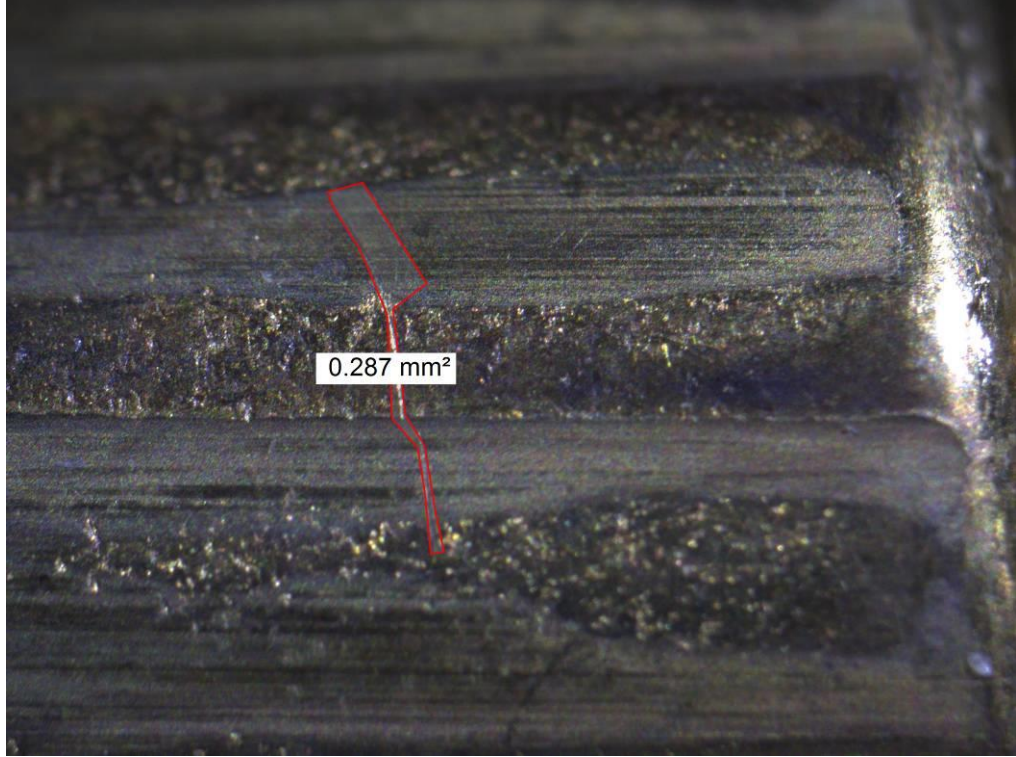
Şekil 3.18. Yirminci Mermi Çekirdeği Üzerinde Oluşan Penset İzi
