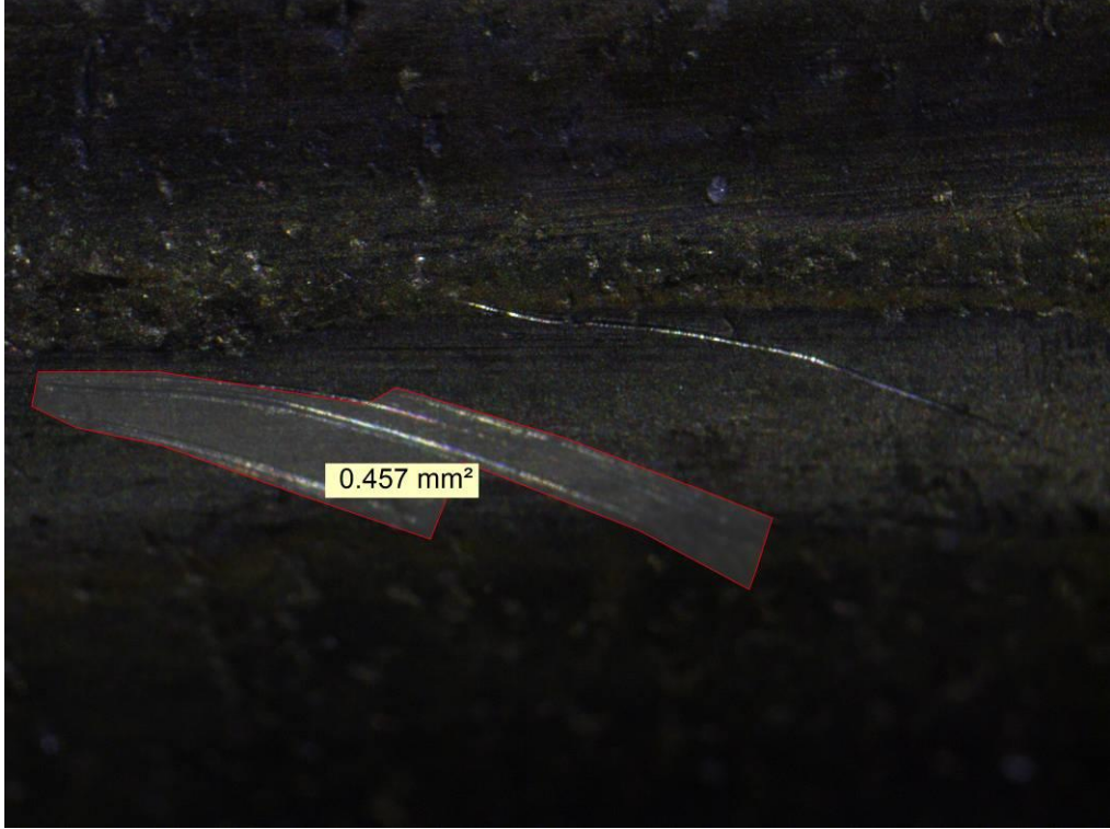
Şekil 3.78. Otuz Dokuzuncu Mermi Çekirdeği Üzerinde Oluşan Penset İzleri
