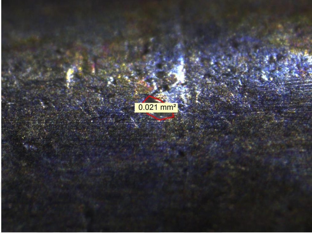
Şekil 3.52. On Yedinci Mermi Çekirdeği Üzerinde Oluşan Penset İzi
