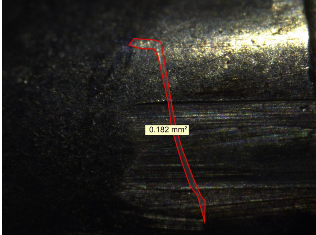
Şekil 3.37. Dördüncü Mermi Çekirdeği Üzerinde Oluşan Penset İzi
