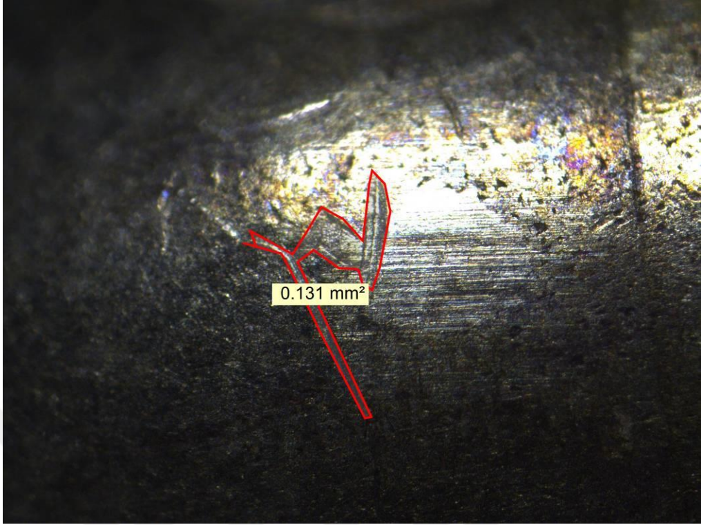
Şekil 3.60. Yirmi Dördüncü Mermi Çekirdeği Üzerinde Oluşan Penset İzi
