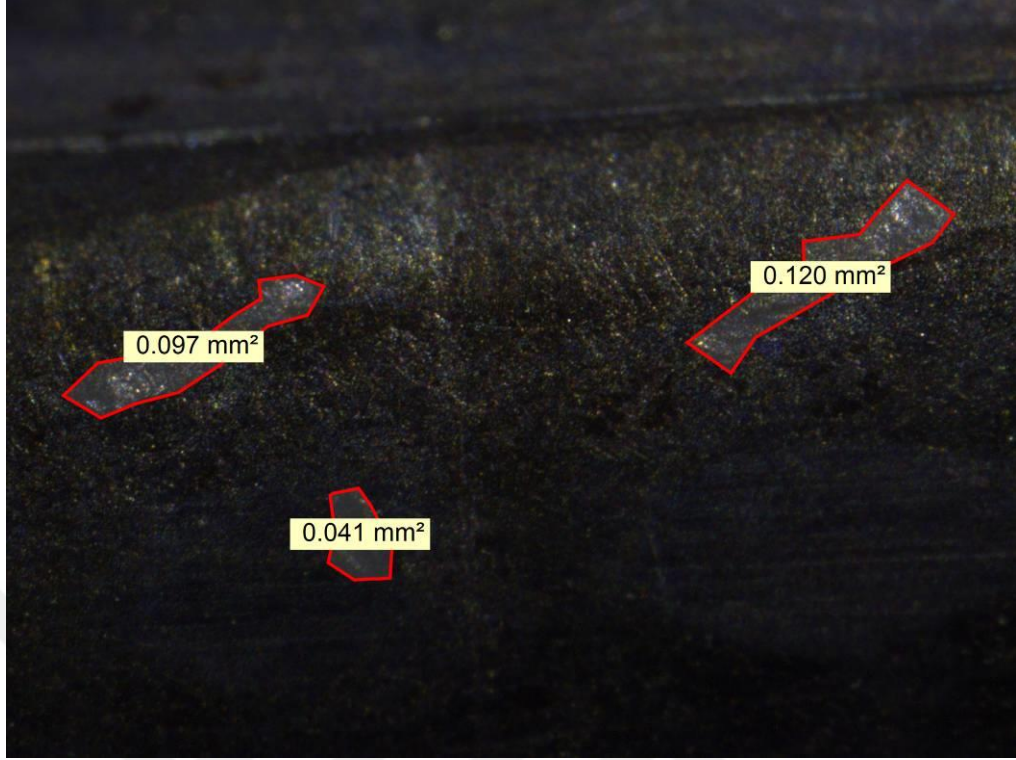
Şekil 3.145. Altmışıncı Mermi Çekirdeği Üzerinde Oluşan Penset İzleri
