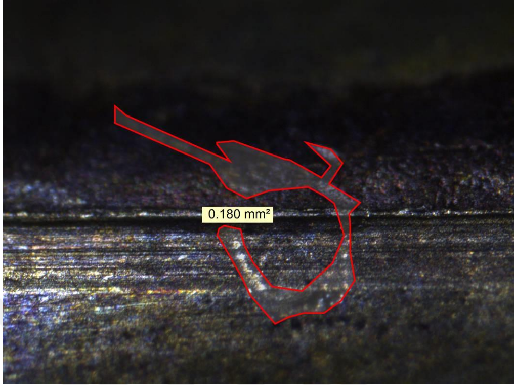
Şekil 3.62. Yirmi Beşinci Mermi Çekirdeği Üzerinde Oluşan Penset İzi
