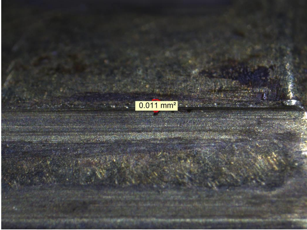
Şekil 3.135. Elli Üçüncü Mermi Çekirdeği Üzerinde Oluşan Penset İzi
