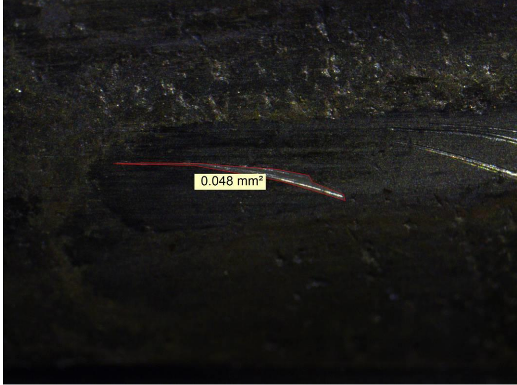
Şekil 3.76. Otuz Dokuzuncu Mermi Çekirdeği Üzerinde Oluşan Penset İzi
