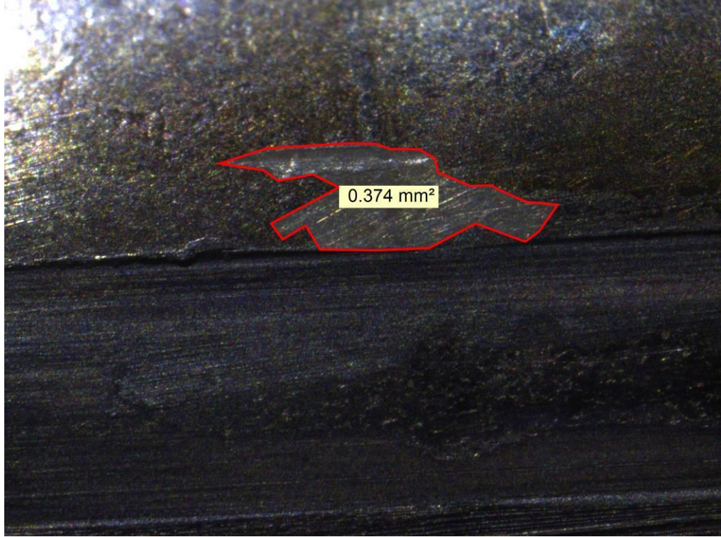
Şekil 3.126. Otuz Sekizinci Mermi Çekirdeği Üzerinde Oluşan Penset İzi
