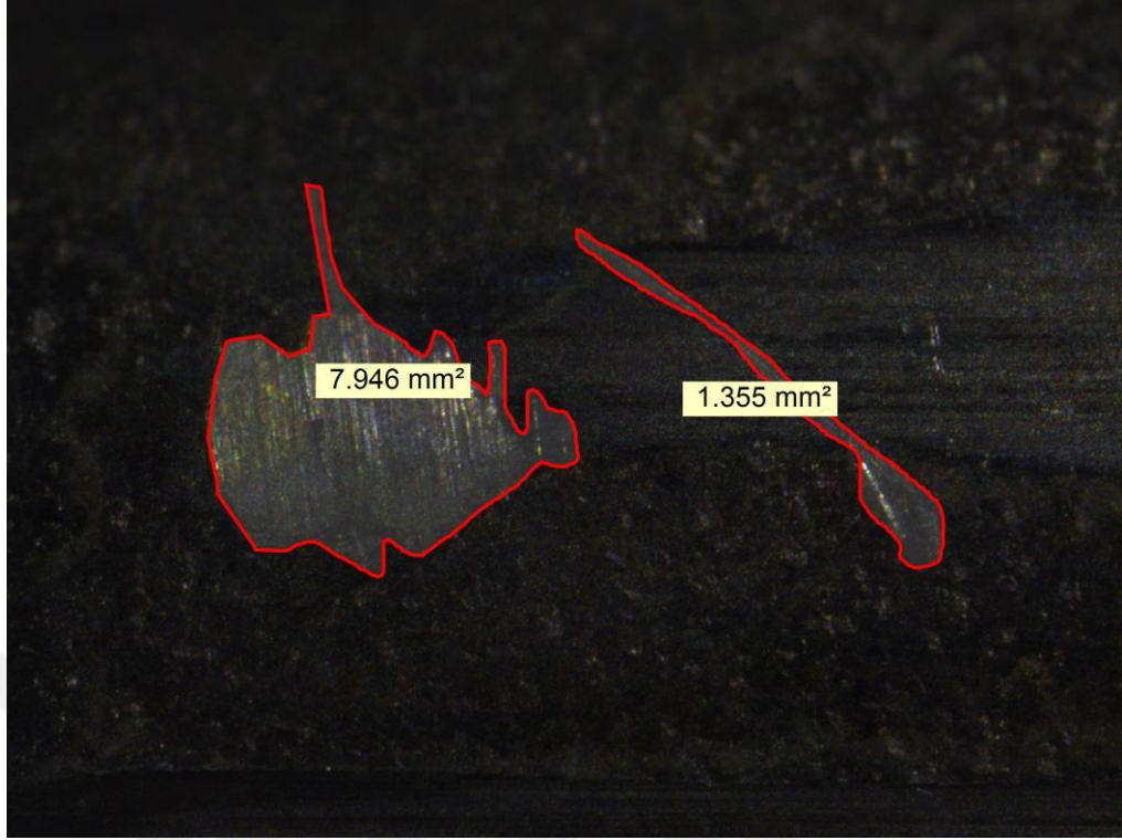
Şekil 3.89. Kırk Yedinci Mermi Çekirdeği Üzerinde Oluşan Penset İzleri
