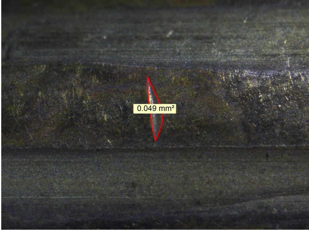
Şekil 3.80. Kırkıncı Mermi Çekirdeği Üzerinde Oluşan Penset İzi
