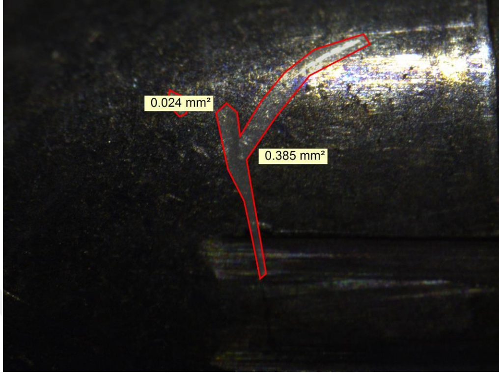
Şekil 3.36. Dördüncü Mermi Çekirdeği Üzerinde Oluşan Penset İzleri
