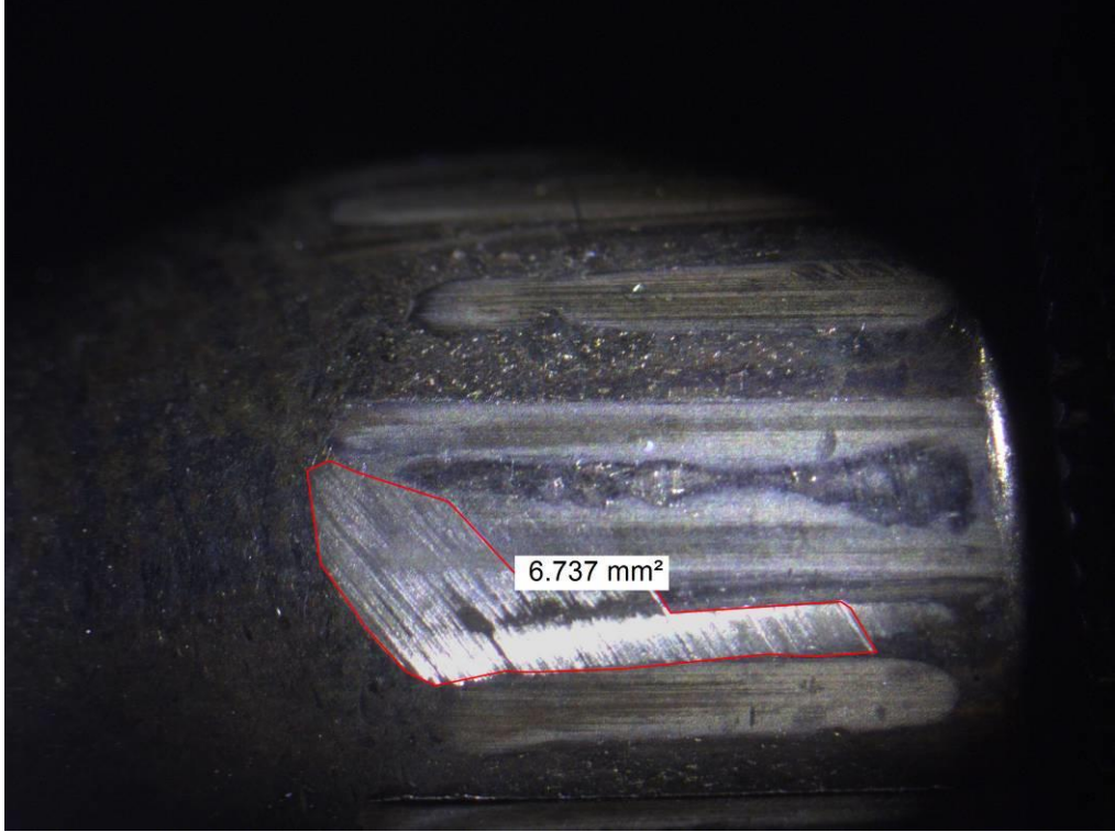
Şekil 3.30. Yirmi Dokuzuncu Mermi Çekirdeği Üzerinde Oluşan Penset İzi
