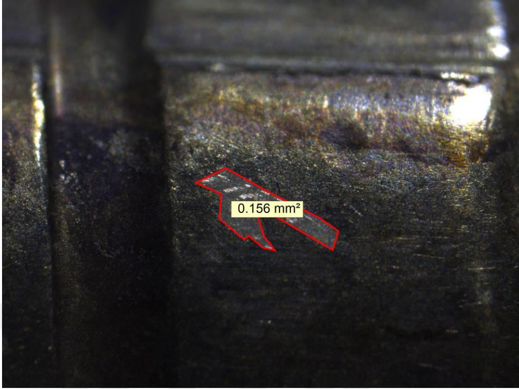
Şekil 3.46. On Birinci Mermi Çekirdeği Üzerinde Oluşan Penset İzi
