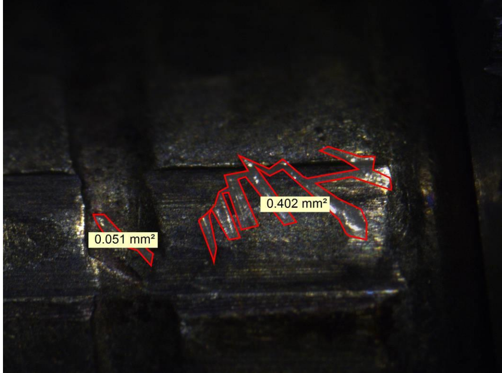
Şekil 3.59. Yirmi İkinci Mermi Çekirdeği Üzerinde Oluşan Penset İzleri
