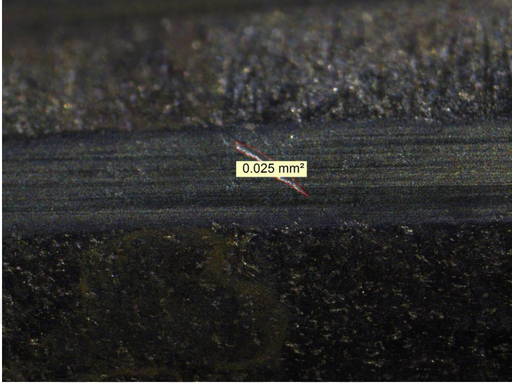
Şekil 3.103. Elli Altıncı Mermi Çekirdeği Üzerinde Oluşan Penset İzi
