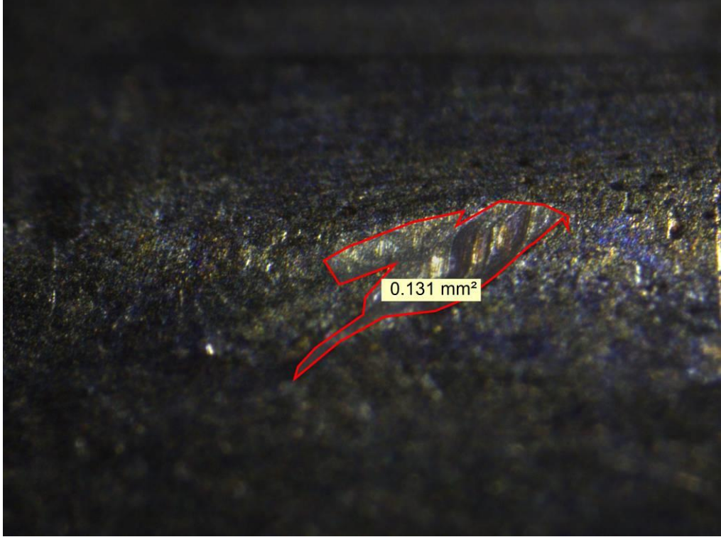
Şekil 3.61. Yirmi Beşinci Mermi Çekirdeği Üzerinde Oluşan Penset İzi
