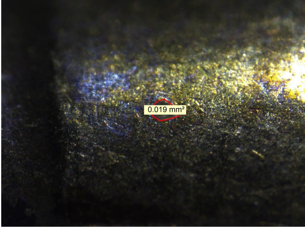
Şekil 3.39. Yedinci Mermi Çekirdeği Üzerinde Oluşan Penset İzi
