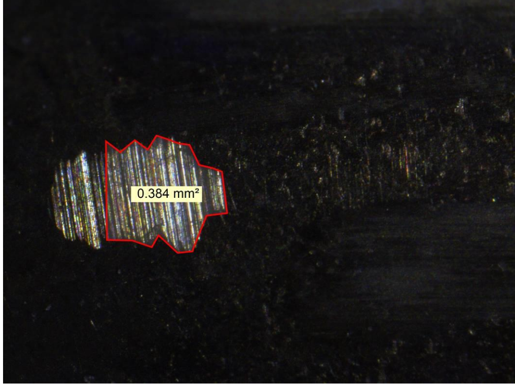
Şekil 3.90. Kırk Yedinci Mermi Çekirdeği Üzerinde Oluşan Penset İzleri
