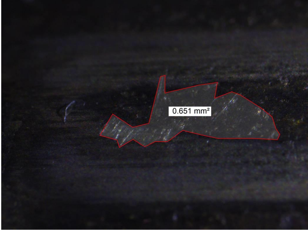
Şekil 3.28. Yirmi Yedinci Mermi Çekirdeği Üzerinde Oluşan Penset İzi
