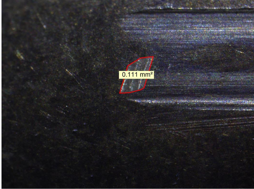
Şekil 3.124. Otuz Altıncı Mermi Çekirdeği Üzerinde Oluşan Penset İzi
