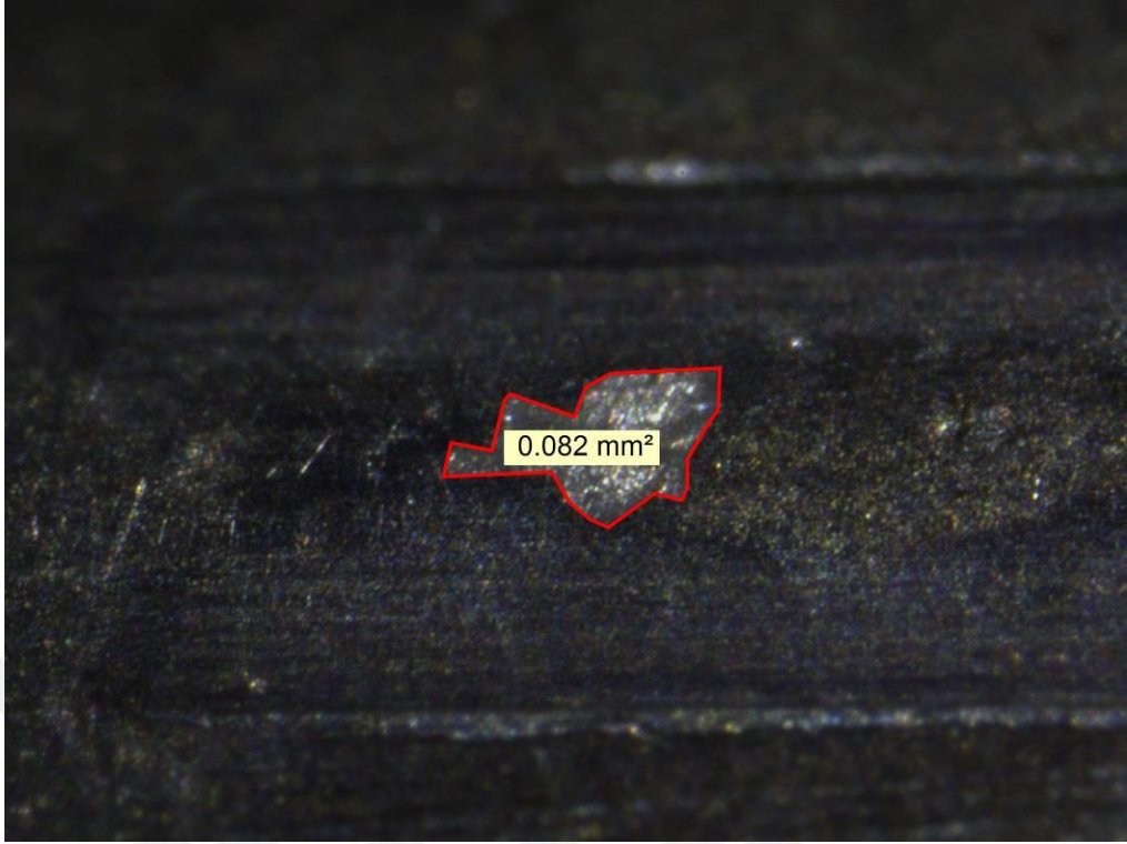
Şekil 3.66. Yirmi Sekizinci Mermi Çekirdeği Üzerinde Oluşan Penset İzi
