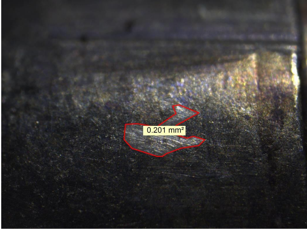
Şekil 3.45. On Birinci Mermi Çekirdeği Üzerinde Oluşan Penset İzi
