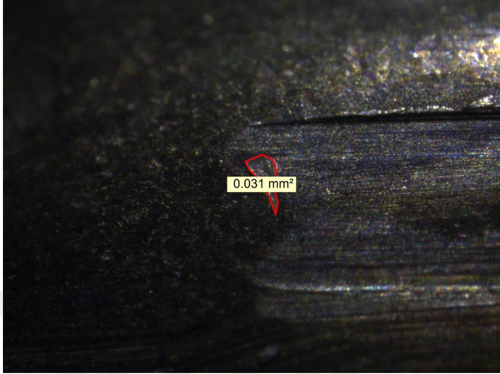
Şekil 3.129. Kırk Birinci Mermi Çekirdeği Üzerinde Oluşan Penset İzi
