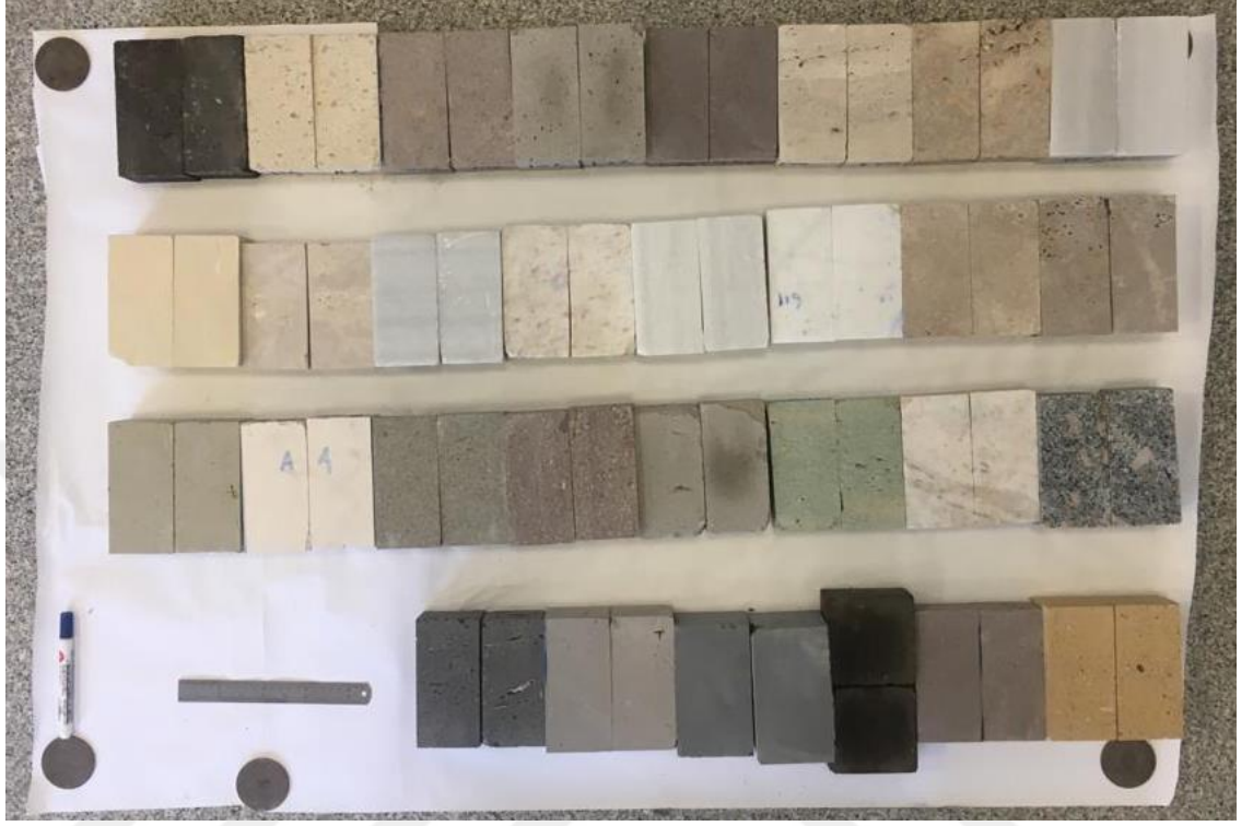
Şekil 3.19 Temel sürtünme açılarının belirlenmesi amacıyla kesilmiş ve zımparalanmış numuneler
