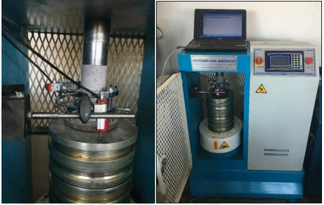
Şekil 3.9 Tek eksenli sıkışma deney düzeneğinin görünümü
