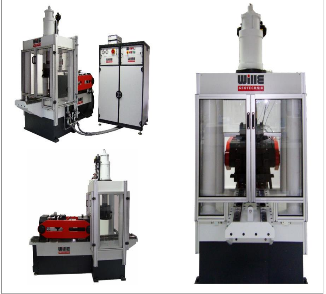
Şekil 3.7 Araştırmada kullanılan kesme kutusu cihazının değişik açılardan görünümü
