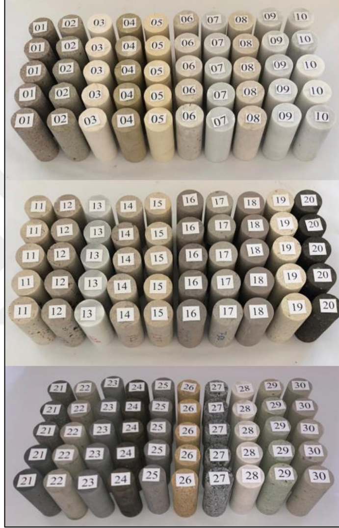
Şekil 3.8 Tek eksenli sıkışma deneyine hazır hale getirilen numuneler
