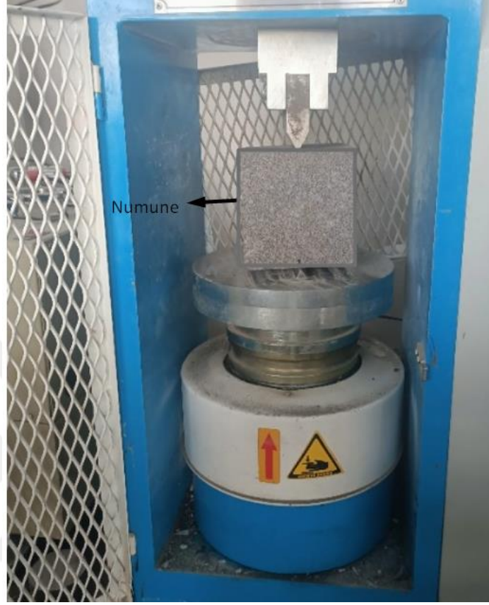
Şekil 3.10 Baltalı pres düzeneğinde kübik numunelerde yapay süreksizlik oluşturulması
