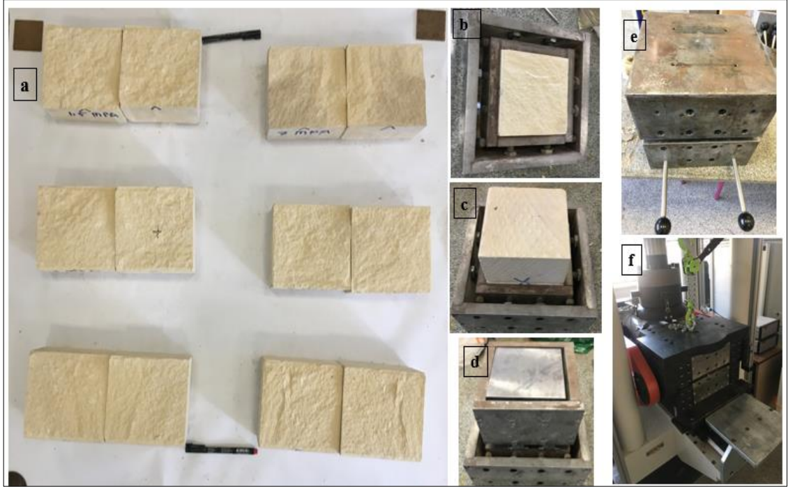
Şekil 3.22 Kesme deneyine hazırlık aşamaları
