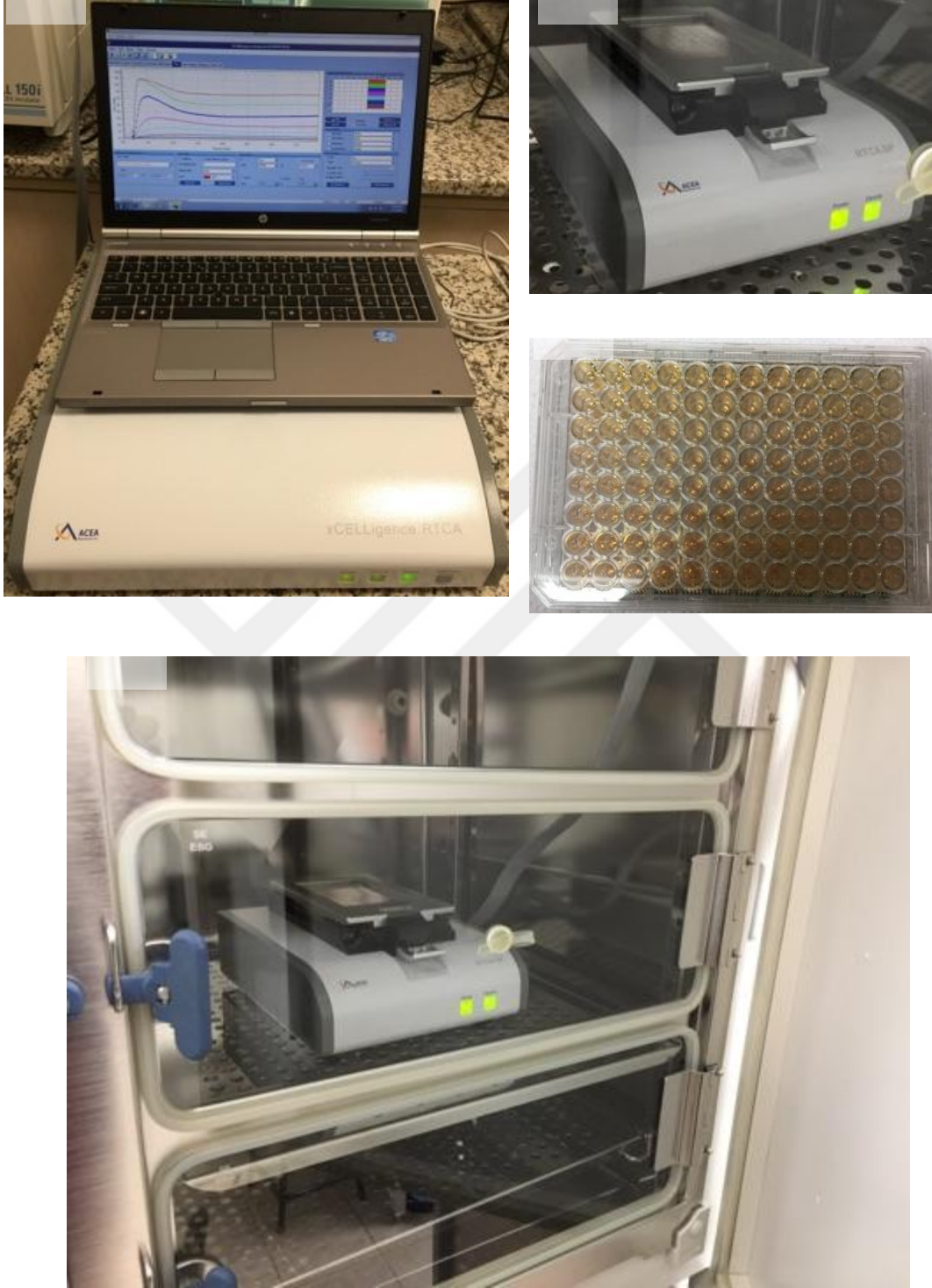
Şekil 4.4. Eş-zamanlı hücre analizi sistemi. (A) Bilgisayar ve EZHA analizörü, (B) EZHA SP istasyonu, (C) 96 kuyucuklu e-plaka. (D) EZHA istasyonu.
