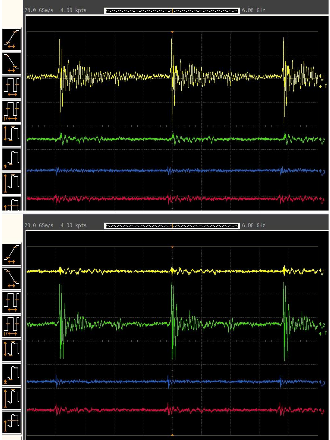
Şekil 4.25 Telin 1 numaralı antene yakın olduğu durum (üst resim) ve telin 2 numaralı antene yakın olduğu durum (alt resim)
