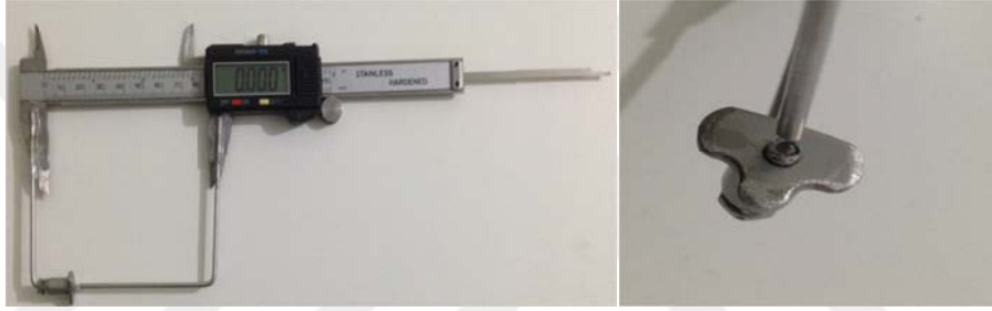
Şekil 2. 3: 0,01 mm hassasiyetli acetabulum'un içinden pelvis içine uzanabilen, ölçüm kolları uzatılmış, dijital kumpaslar ile eklem yüzüne dik ölçüm sağlamak amacı ile dijital kumpasın acetabulum içine yerleştirilen koluna adapte edilen eklem yüzüne tam oturan üç nokta prensibi ile işleyen özel aparat.
