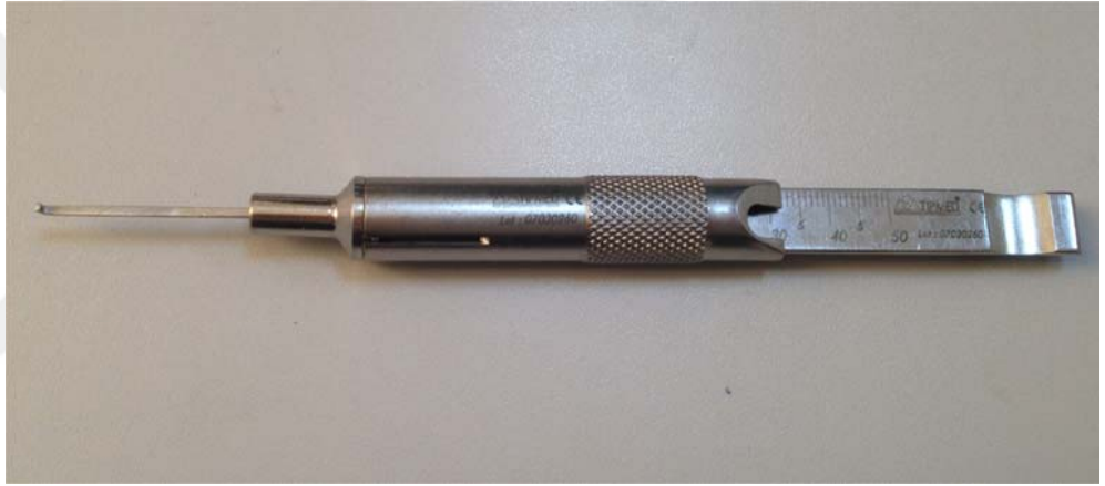
Şekil 1. 16: Vida deliklerinin boyunu ölçmek için kullanılan ölçücünün görüntüsü.
