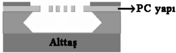
Şekil 2.9 Havada asılı fotonik kristal dilim yapının üretildiği şematik görünüşü (Carlsson vd. 2002)
