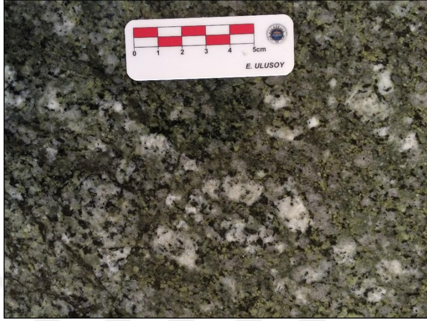
Şekil 4.68 İkiztepe Granitoyidi genel dokusu, porfirik ortoklaz kristalleri, epidot segregasyonlarının yakın plan görüntüsü (İstihkam Tepe)
