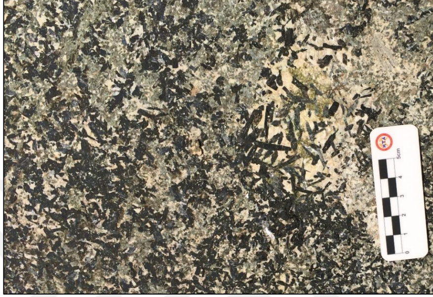
Şekil 4.49 Gabrolar içinde gözlenen ince-uzun prizmatik kristaller halinde gelişen mafik mineral segregasyonu
