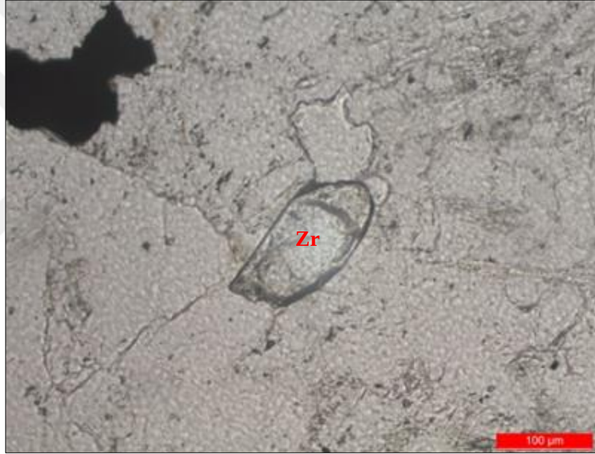
Şekil 7.12 U-Pb jeokronolojisi örnek seçilmesinde petrografik incelemelere göre tespit edilen yarı özşekli, prizmatik zirkon kristallerine bir örnek (10x, PPL görüntüsü, Zr: zirkon)
