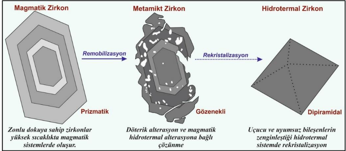
Şekil 7.13 Farklı zirkon türleri ve bunların oluşumunun genel olarak şematize çizimi; a) yüksek sıcaklıkta bir ilksel magmadan türemiş magmatik zirkon, b) magmatik-hidrotermal geçişi sırasında değişme ve çözünme yoluyla oluşan metamikt zirkon, c) Zr-doygun hidrotermal sıvılardan yeniden kristallenmiş hidrotermal zirkon (Yang vd. (2013) değiştirilmiştir).
