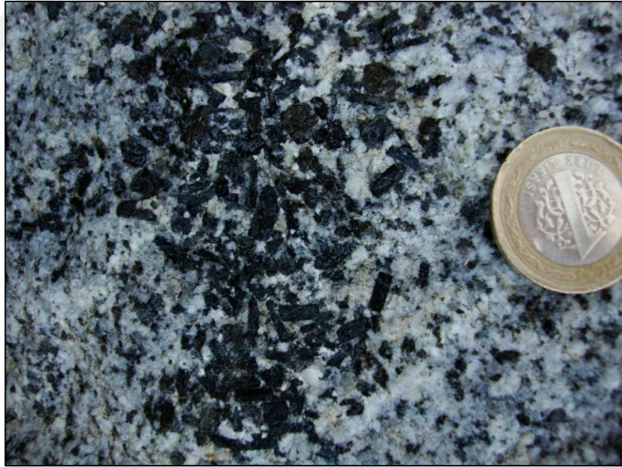
Şekil 4.12 Hamdibey köyü güneyi Mezar Tepe dolaylarında gözlenen monzogranit içinde magma segregasyonu tipi anklav
