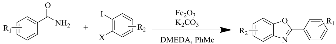
Şekil 1.105. Benzamitten hareketle 2-süstitüe benzoksazol sentezi
