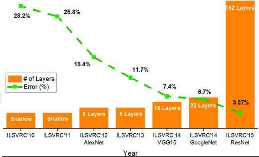
Şekil 4.7 ILSVCR yarışmasında kullanılan modeller katman sayıları ve elde edilen hata oranları (Wang vd. 2018)
