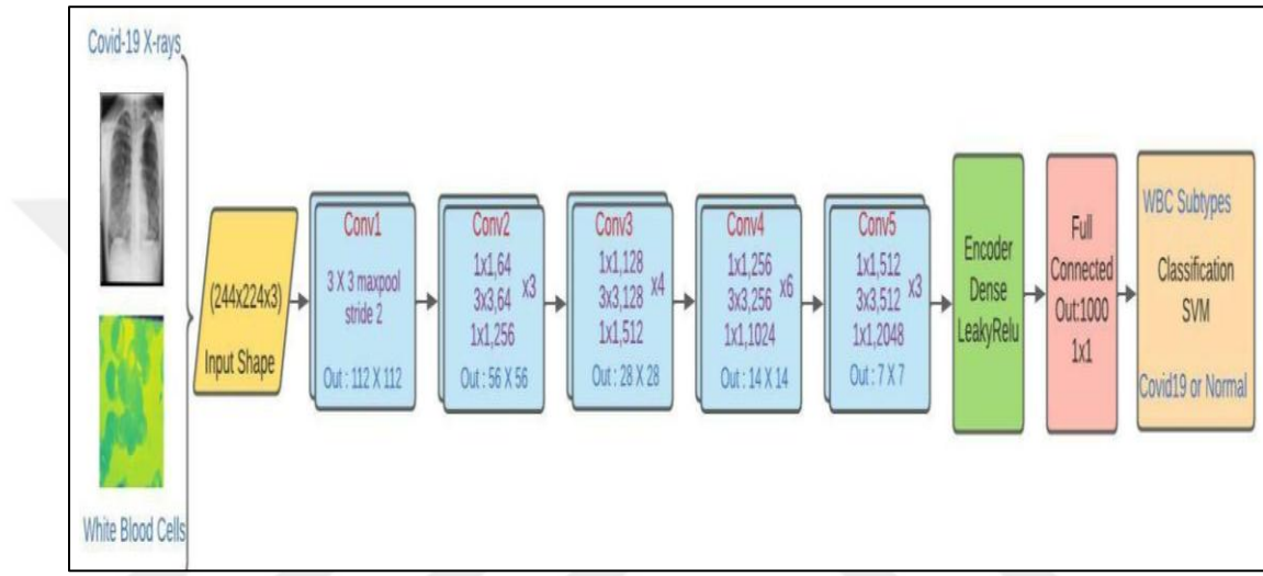
Şekil 4.9 Önerilen model Resnet50+AE+SVM veri kümesi
