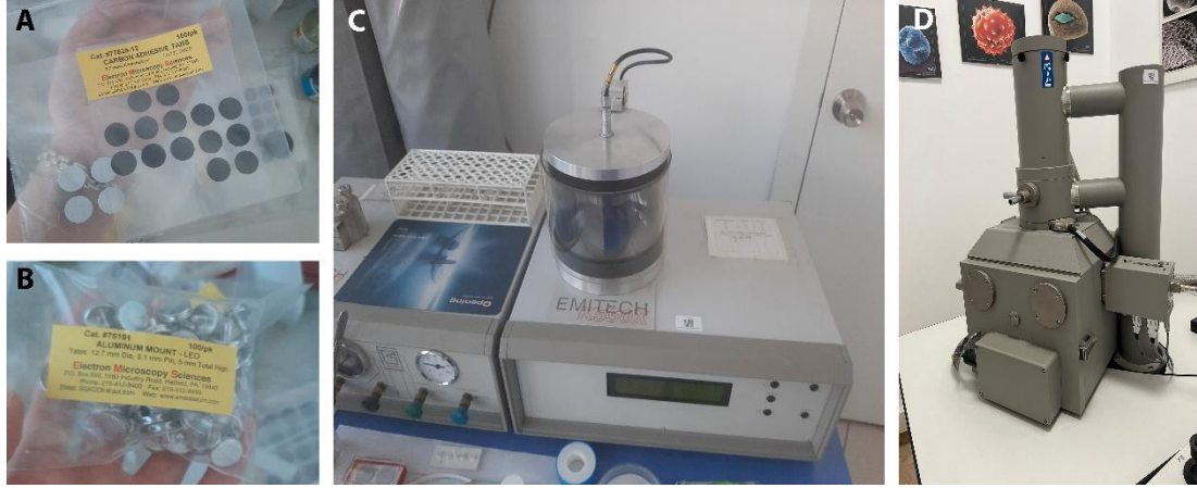
Şekil 2.9: Taramalı elektron mikroskopi. Örnekler karbon kaplı ve alüminyum tutacak (stab) ve cam lamellere tutturuldu (A ve B). Örnekler vakumla altın-paladyum ile kaplandı (C) ve taramalı elektron mikroskobunda incelendi (D).
