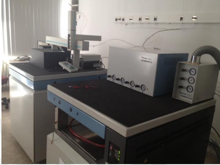
Şekil 4.6 ODTÜ Merkez Laboratuvarı'nda Bulunan İzotop Oranı Kütle Spektrometresi (IRMS) Cihazı
