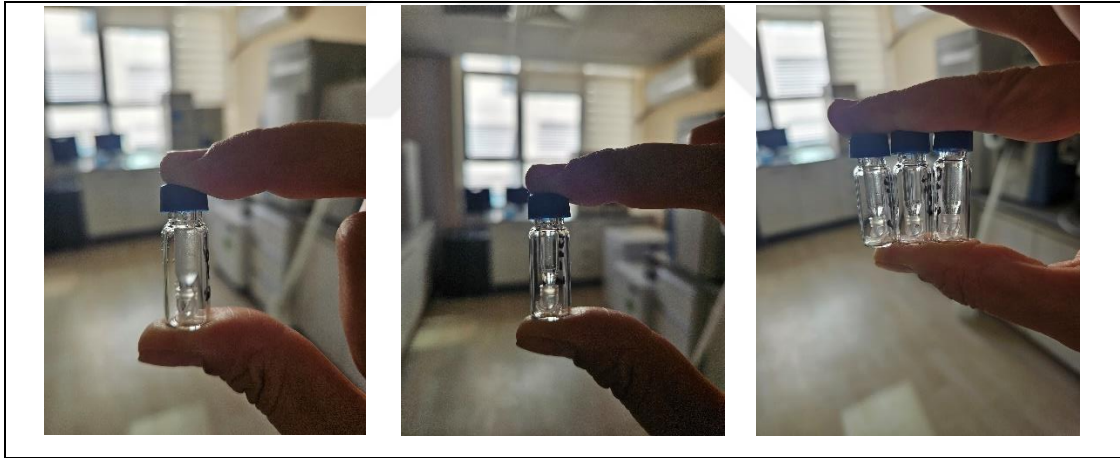
Şekil 4.2 MDD ile hazırlanan numunelerdeki bulutsu yapı ve ardından gerçekleşen zahiri berraklıktaki faz ayrımı
