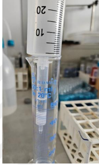
Şekil 3.5 Peynirden aflatoksin M1'in immunoaffinite kolon ile elüsyonu
