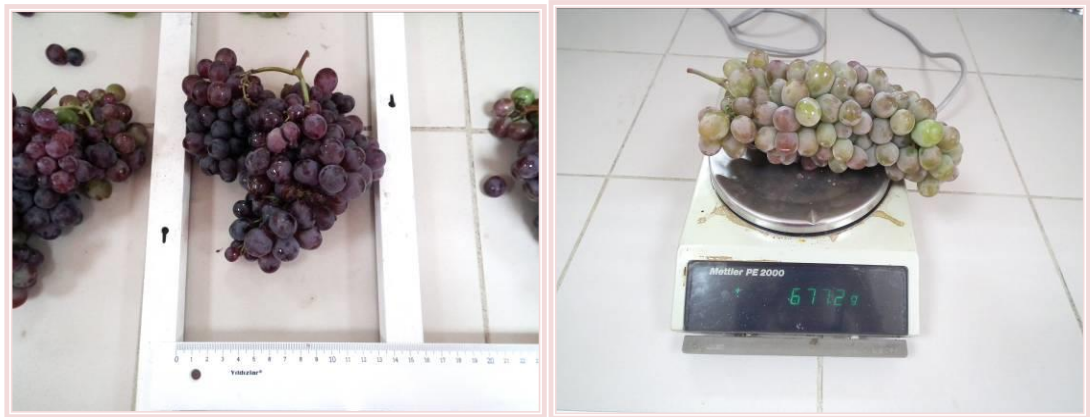
Şekil 4.5 Salkım uzunluk ve ağırlık ölçümleri
