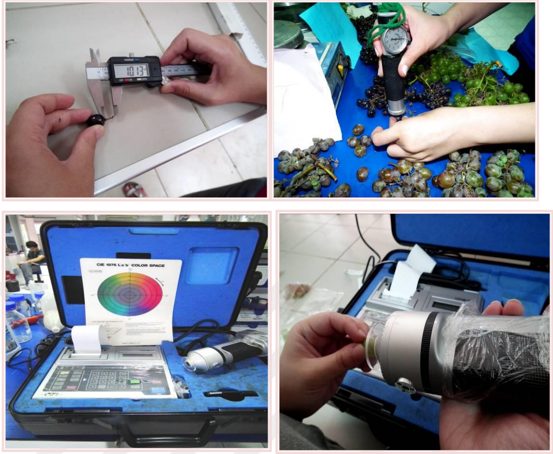
Şekil 4.6 Tane sapı uzunluğu, sertlik ve renk ölçümlerine ait görüntüler
