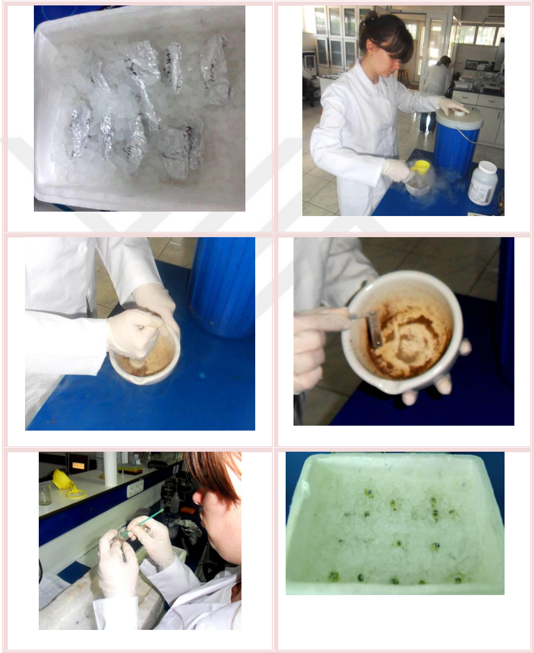
Şekil 4.9 -80 °C’de muhafaza edilen genç yaprak ve sürgün uçlarının sıvı azotla porselen havanda ezilerek 2 µl ependorf tüplere aktarılması
