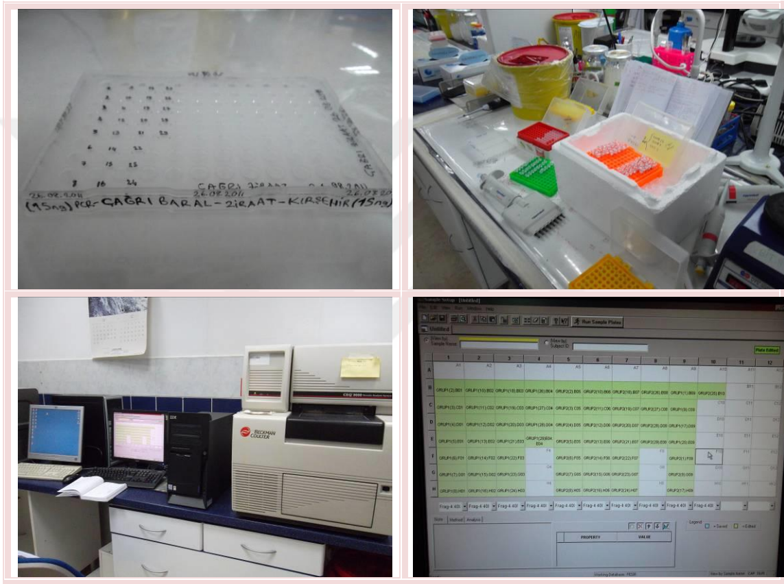
Şekil 4.13 Kapilleri elektroforez işlemi hazırlığı ve Beckman CEQTM 8800 Genetik Analiz Sistemi
