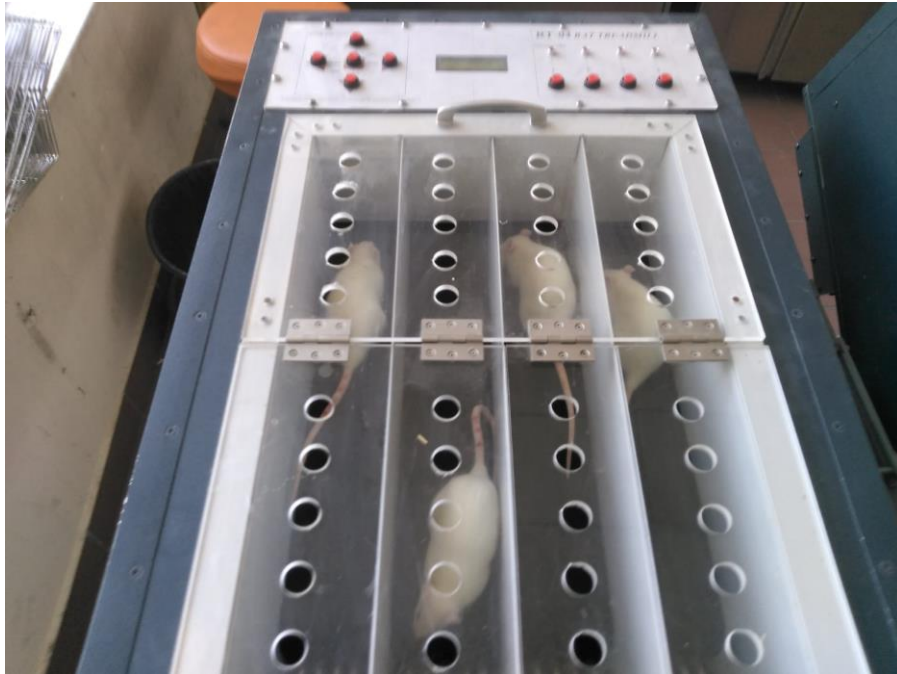
Şekil 3.2. Hızı, eğimi kontrol edilebilen ve ceza uygulamasına olanak veren küçük deney hayvanları koşu bandı.
