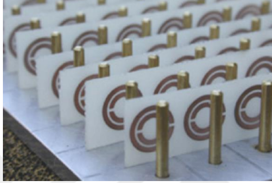
Şekil 2.6 İlk kez sentezlenen Negatif Kırılma ortamının yapısı. Fotoğraf Dr. Smith ait.
