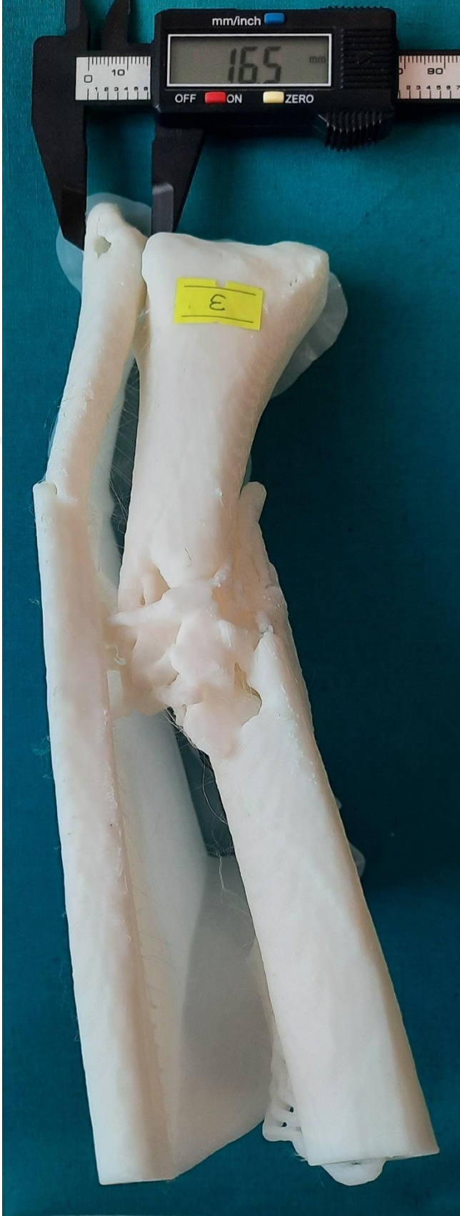
Şekil 2.8.3. Belirlenen noktalardan manuel ölçümlerin yapılması (Vaka 3)
