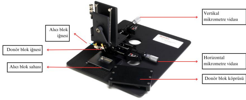
Şekil 5.1.2. Her bir vakanın iki farklı bloğundan iki tane birer milimetrelik korlar manuel olarak alınarak, şekildeki cihaz yardımı ile toplam 6 adet TMA bloğu oluşturulmuştur (Beecher Manual Tissue Arrayer, Model-MTA1)
