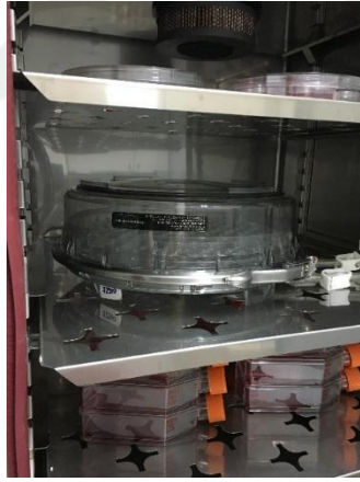
Şekil 2.1. Chamber 'ın resmi (A) ve içindeki oksijen konsantrasyonunun düşürülmesini gösteren örnek trase (B). Normal atmosfer basıncındaki (normoksi) oksijen (~158 mmHg, % 100) hipoksi sırasında % 3'e (~4-5 mmHg) düşmektedir.
