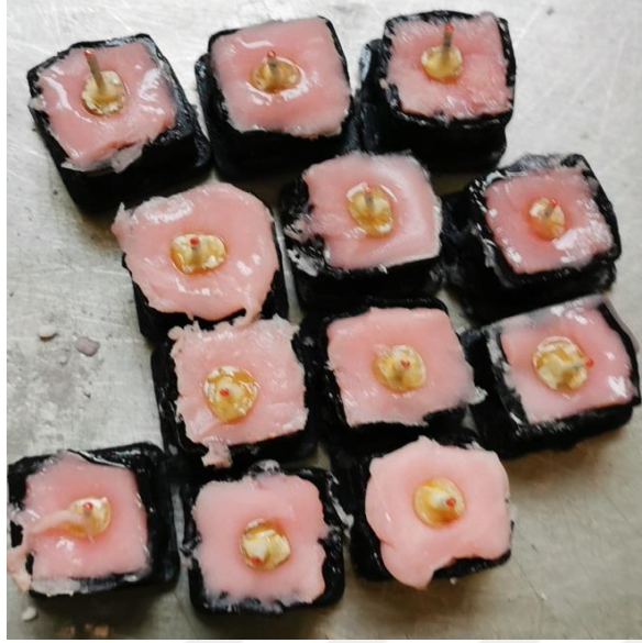
Şekil 2.6. Fiber post yerleştirilmiş örneklerin akrile gömülmesi
