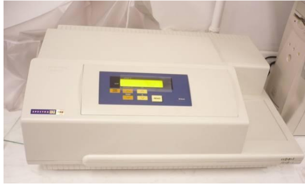
Şekil 2.13. Spektrofotometrik analizin yapıldığı cihaz (SpectraMax 190)
