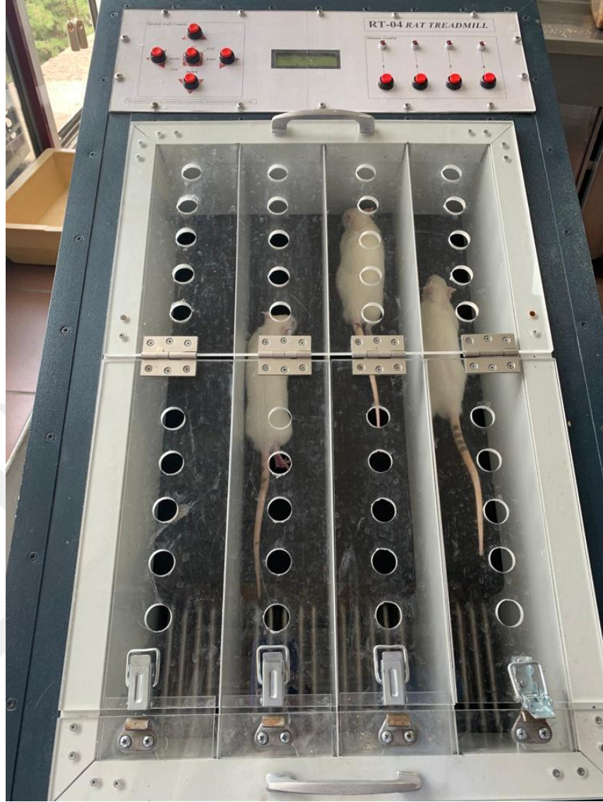
Şekil 2.1. Hızı, eğimi kontrol edilebilen küçük deney hayvanları koşu bandı
