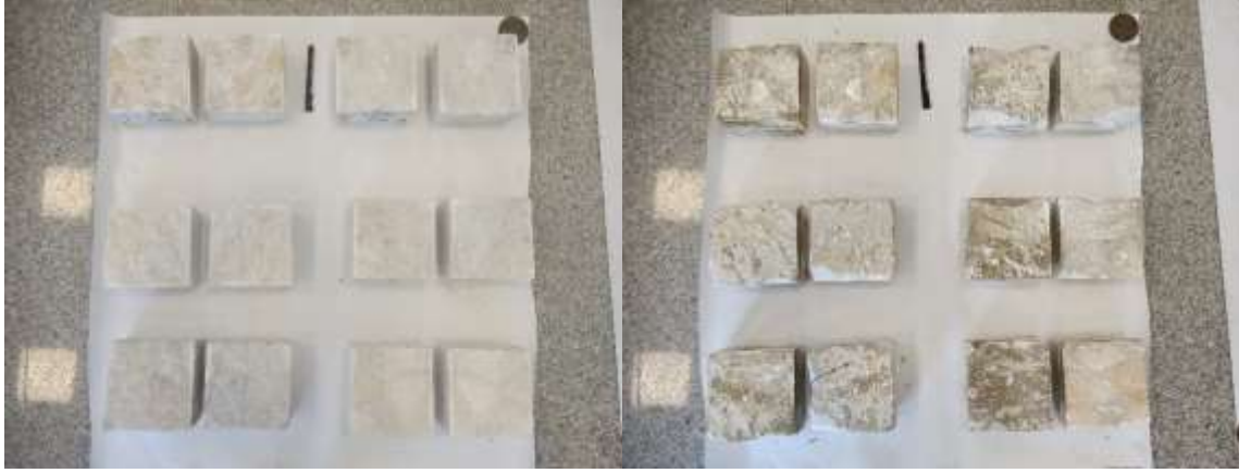
MY-2 Mermer kayasında 1 mm kalınlıkta sert dolgu malzemesi-2 ile gerekleřtirilen dinamik kesme deney numunelerinin, deneyler ncesi ve sonrası grnmleri
