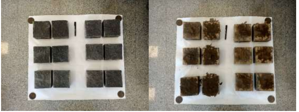
MY-1 Diyarbaz kayasında 5 mm kalınlıkta yumuřak dolgu ile gerekleřtirilen dinamik kesme deney numunelerinin, deneyler ncesi ve sonrası grnmleri
