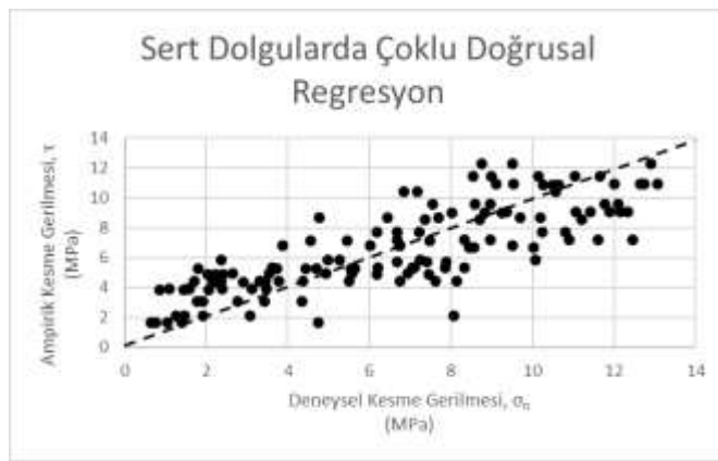
Şekil 4.30 Sert dolgularda çoklu doğrusal regresyon için deneysel ve ampirik dinamik kesme dayanımı karşılaştırma grafiği
