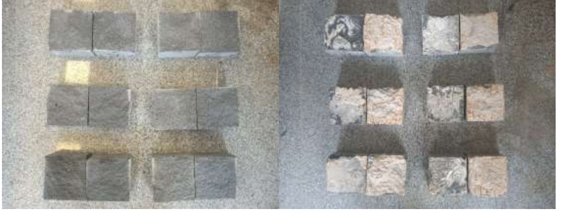
MY-1 Diyabaz kayasında 5 mm kalınlıkta sert dolgu malzemesi-1 ile gerekleřtirilen dinamik kesme deney numunelerinin, deneyler ncesi ve sonrası grnmleri
