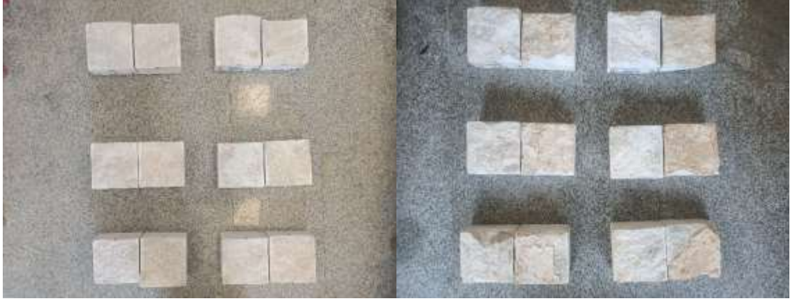
MY-2 Mermer kayasında 3 mm kalınlıkta sert dolgu malzemesi-1 ile gerekleřtirilen dinamik kesme deney numunelerinin, deneyler ncesi ve sonrası grnmleri
