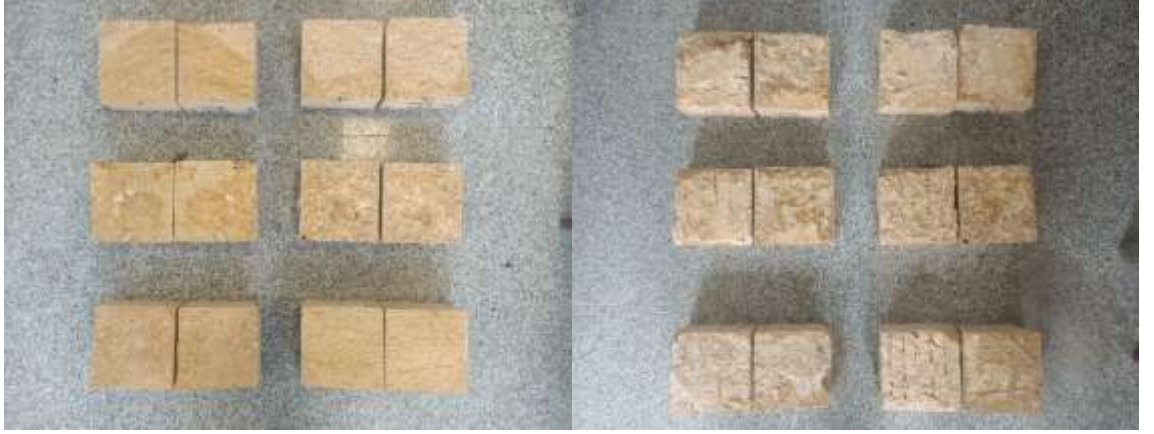
MY-3 Litik Tüf kayasında 5 mm kalınlıkta sert dolgu malzemesi-1 ile gerçekleştirilen dinamik kesme deney numunelerinin, deneyler öncesi ve sonrası görünümü
