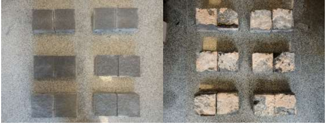
MY-1 Diyabaz kayasında 3 mm kalınlıkta sert dolgu malzemesi-1 ile gerekleřtirilen dinamik kesme deney numunelerinin, deneyler ncesi ve sonrası grnmleri
