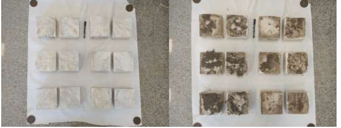
MY-2 Mermer kayasında 3 mm kalınlıkta yumuřak dolgu ile gerekleřtirilen dinamik kesme deney numunelerinin, deneyler ncesi ve sonrası grnmleri
