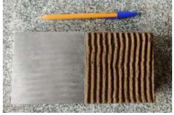
Şekil 3.18 Testere ağzı dişli yayma tarakları (solda), 4 mm dişli tarakla kalınlığı ayarlanan ve spreylene numune (sağda)
