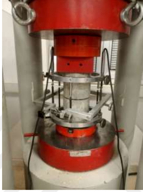
Şekil 3.22 Beton silindir bloklar arasına uygulanan yumuşak dolgu ve LVDT cihazlarının yerleşimi
