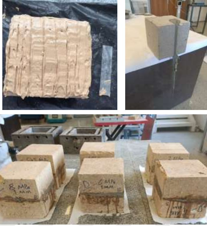
Şekil 3.23 Sert dolgu malzemesi-1 için yayma tarakları ile kalınlık ayarlaması (sol üstte), kumpas ile kalınlık ölçümleri (sağ üstte), 1 mm kalınlıkta hazırlanan 1 set numune (altta)
