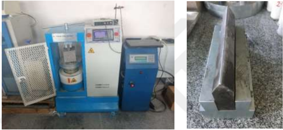
Şekil 3.7 Yapay süreksizliklerin hazırlanmasında kullanılan hidrolik pres ve balta ağzına benzer başlık
