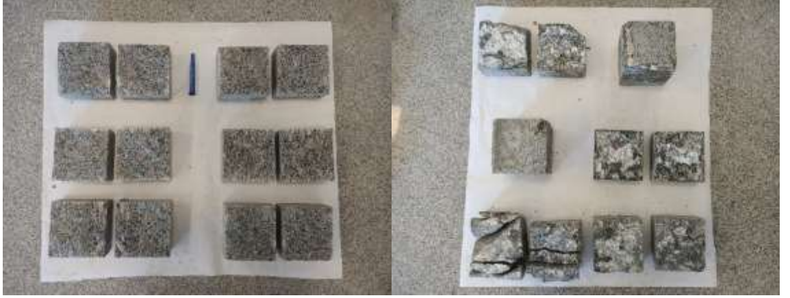
MY-6 Granodiyorit kayasında 1 mm kalınlıkta sert dolgu malzemesi-2 ile gerekleřtirilen dinamik kesme deney numunelerinin, deneyler ncesi ve sonrası grnmleri
