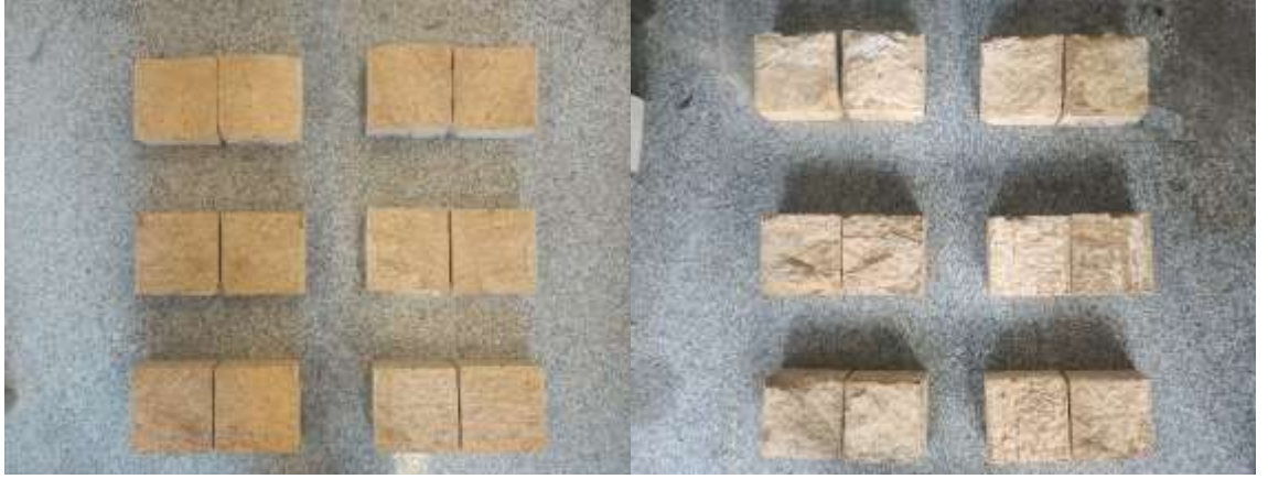
MY-3 Litik Tf kayasında 3 mm kalınlıkta sert dolgu malzemesi-1 ile gerekleřtirilen dinamik kesme deney numunelerinin, deneyler ncesi ve sonrası grnmleri
