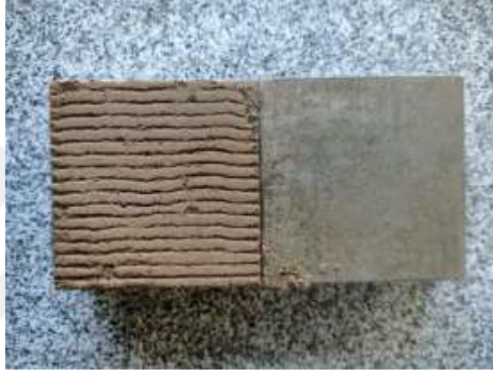
Şekil 3.19 4 mm dişli tarakla kalınlığı ayarlanan ve spreylene numunenin yük uygulandıktan sonraki görünümü
