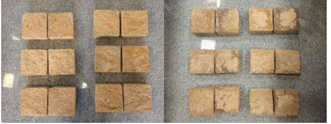
MY-3 Litik Tuf kayasında 3 mm kalınlıkta sert dolgu malzemesi-2 ile gerekleřtirilen dinamik kesme deney numunelerinin, deneyler ncesi ve sonrası grnmleri
