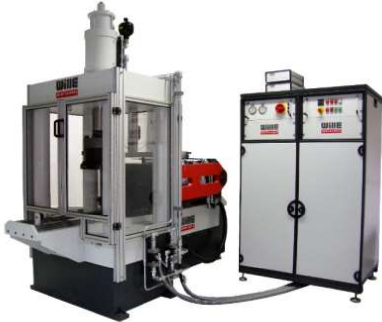
Şekil 3.24 Doğrudan dinamik kesme deney cihazının genel görünümü
