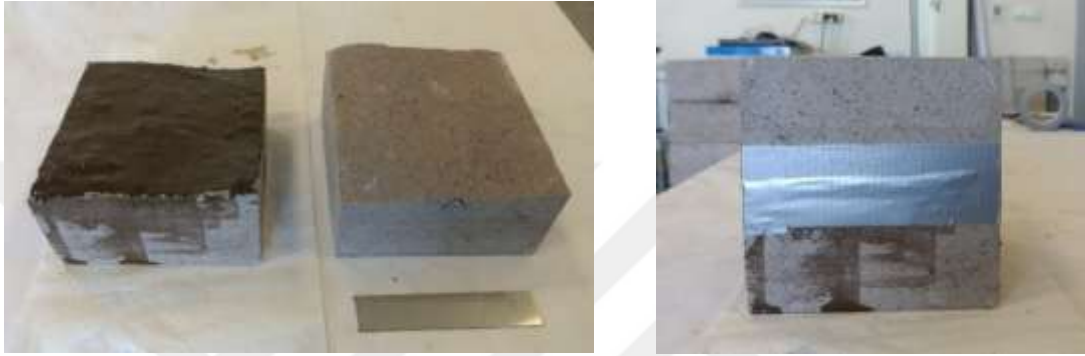
Şekil 3.16 Sert dolgu malzemelerinin uygulanması ve tamir bandıyla sızmaların önlenmesi
