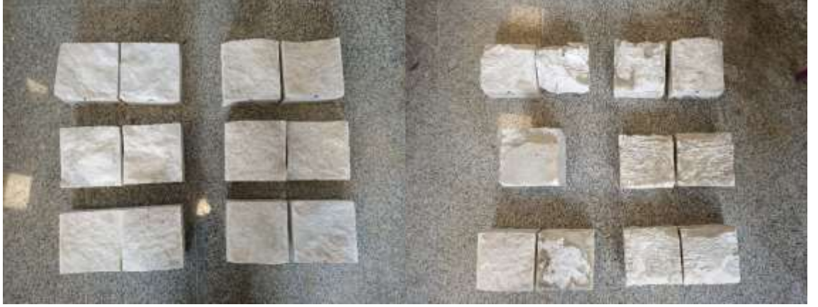
MY-2 Mermer kayasında 3 mm kalınlıkta sert dolgu malzemesi-2 ile gerekleřtirilen dinamik kesme deney numunelerinin, deneyler ncesi ve sonrası grnmleri
