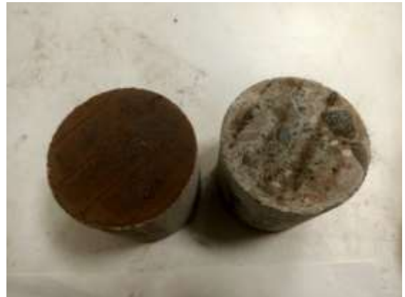
Şekil 3.21 Dolgunun uygulandığı silindir beton numunesi ve aşındırılmış yüzeyleri (solda), 3 mm kalınlıkta ve büzülme limiti su içeriğinde spreylenen dolguya 2 MPa gerilme uygulandıktan sonra dolgunun görünümü (sağda)
