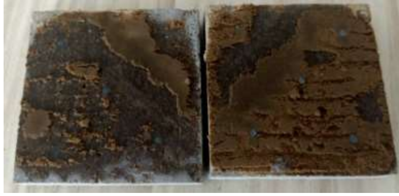
Şekil 3.17 Kesme kutusu denemelerinde çelik bilyelerde oluşan deformasyonların görünümü
