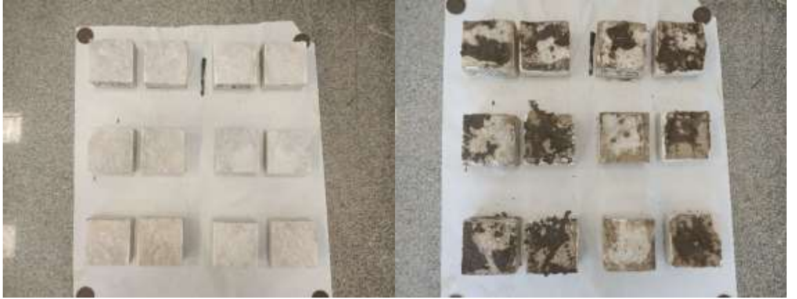
MY-2 Mermer kayasında 5 mm kalınlıkta yumuřak dolgu ile gerekleřtirilen dinamik kesme deney numunelerinin, deneyler ncesi ve sonrası grnmleri
