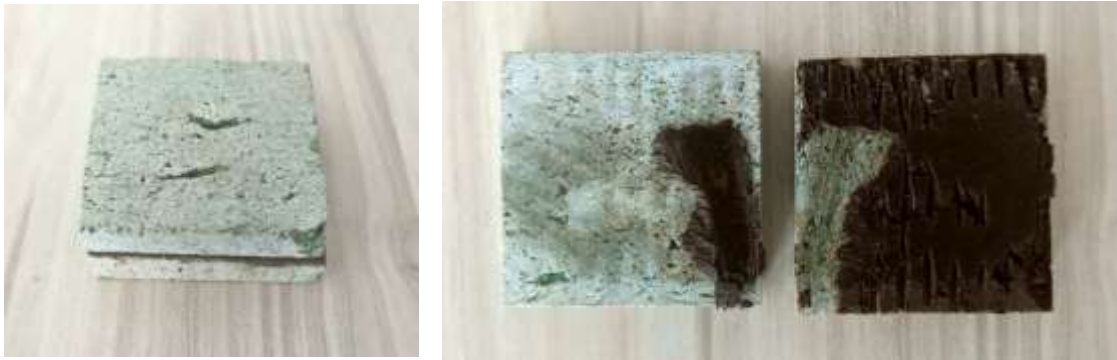
 ekil 3.15 Spreyleme ile hazırlanan dolgulu s reksizlik numunesi ve kesme kutusu deneyi sonrası g r n m  (Solda: iki plaka arasına sandvi lenmi  kil, sa da: ta  plakaların birbirinden ayrılmı  hali. Ta  plaka boyutları 6x6x1 cm'dir)
