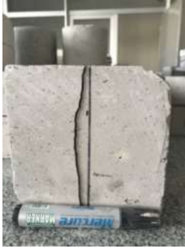
Şekil 3.8 Uygun şekilde yarılmayan ve deneylerde kullanılmayacak numune (solda), uygun şekilde ayrılan numune (sağda) örnekleri
