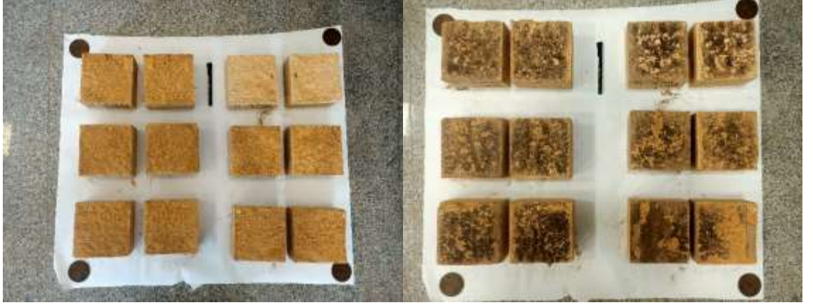
MY-3 Litik Tüf kayasında 1 mm kalınlıkta yumuşak dolgu ile gerçekleştirilen dinamik kesme deney numunelerinin, deneyler öncesi ve sonrası görünümüleri
