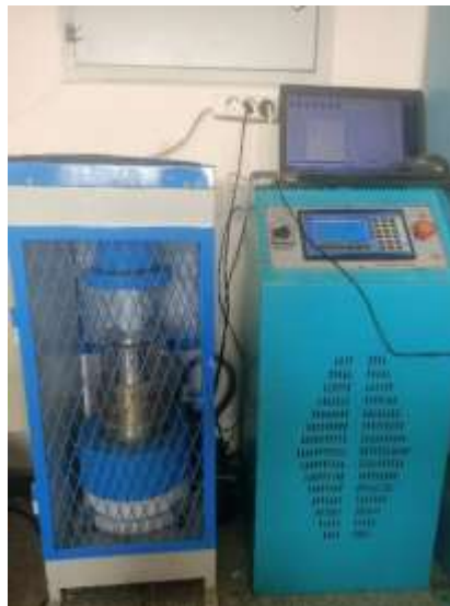
Şekil 3.4 Tek eksenli sıkışma dayanımı deneylerinde kullanılan hidrolik pres
