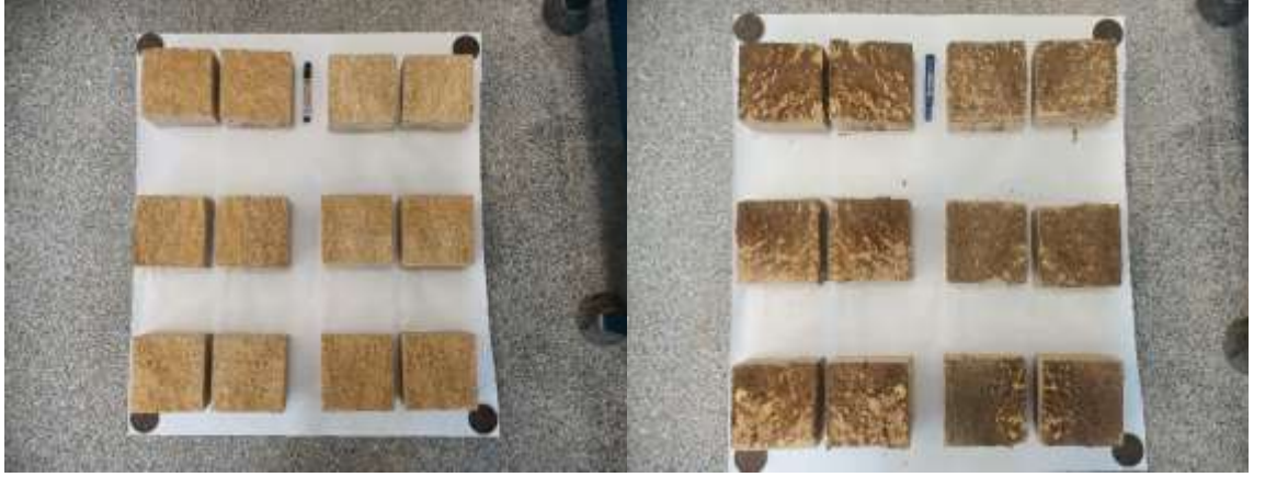
MY-3 Litik Tf kayasında 1 mm kalınlıkta sert dolgu malzemesi-2 ile gerekleřtirilen dinamik kesme deney numunelerinin, deneyler ncesi ve sonrası grnmleri
