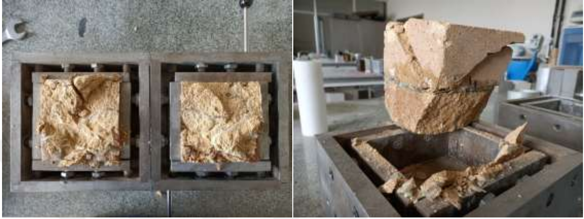
Şekil 4.1 Dolgu malzemesi dayanımının kaya dayanımına eşit veya büyük olduğu dolgulu süreksizliklerde, kesme yenilmesinin kayada gerçekleşmesi (solda) ve kayanın kısmen veya tamamen parçalanması (sağda)
