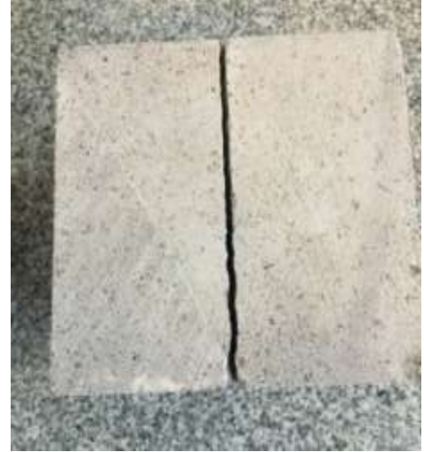
Şekil 3.8 Uygun şekilde yarılmayan ve deneylerde kullanılmayacak numune (solda), uygun şekilde ayrılan numune (sağda) örnekleri
