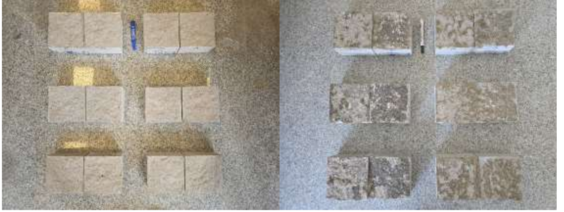
MY-4 Vitrik Tuf kayasında 1 mm kalınlıkta yumuřak dolgu ile gerekleřtirilen dinamik kesme deney numunelerinin, deneyler ncesi ve sonrası grnmleri
