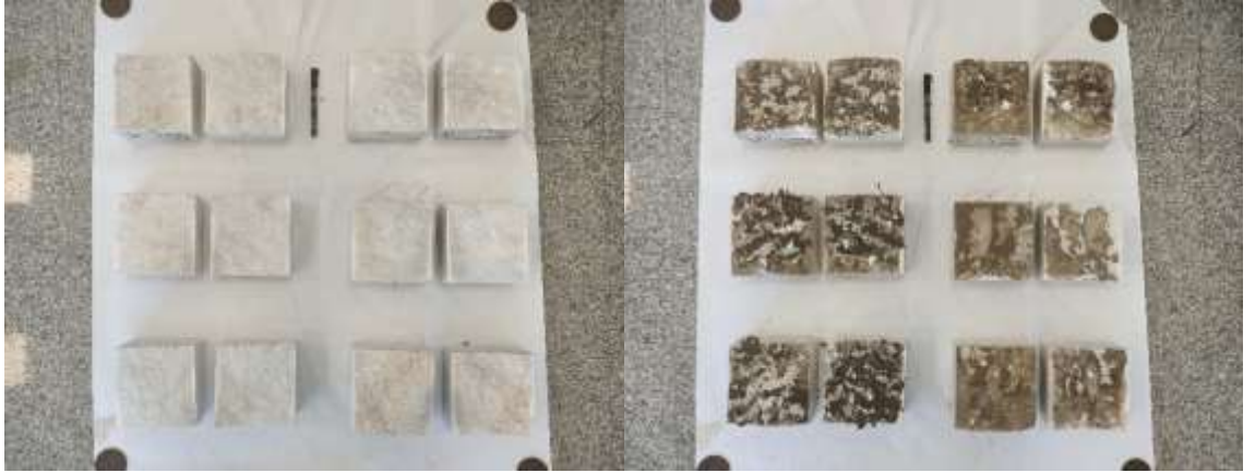
MY-2 Mermer kayasında 1 mm kalınlıkta yumuřak dolgu ile gerekleřtirilen dinamik kesme deney numunelerinin, deneyler ncesi ve sonrası grnmleri
