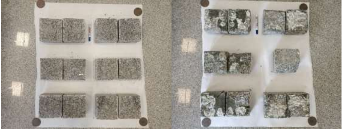
MY-6 Granodiyorit kayasında 5 mm kalınlıkta sert dolgu malzemesi-2 ile gerekleřtirilen dinamik kesme deney numunelerinin, deneyler ncesi ve sonrası grnmleri
