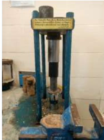
Şekil 3.3 Sert dolgu karışımlarının kalıplardan çıkarılmasında kullanılan hidrolik pres
