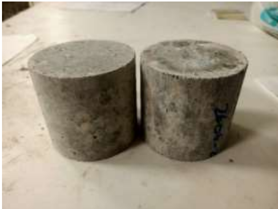
Şekil 3.21 Dolgunun uygulandığı silindir beton numunesi ve aşındırılmış yüzeyleri (solda), 3 mm kalınlıkta ve büzülme limiti su içeriğinde spreylenen dolguya 2 MPa gerilme uygulandıktan sonra dolgunun görünümü (sağda)
