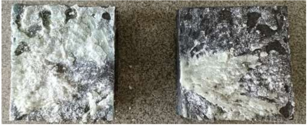
Şekil 4.3 Diyabaz kayasında polyester reçine ve tuz karışımı dolgu malzemesi ile gerçekleştirilen kesme deneyleri sonrası görünümlere bir örnek
