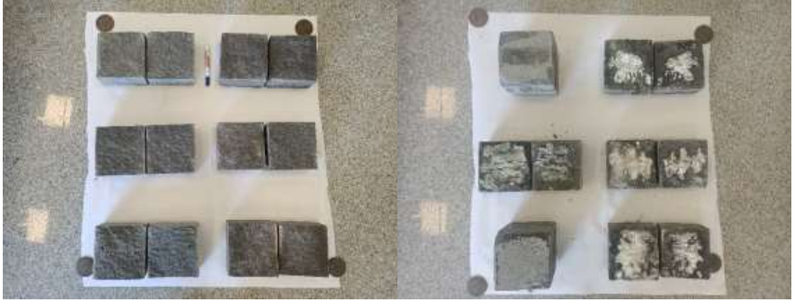
MY-1 Diyabaz kayasında 3 mm kalınlıkta sert dolgu malzemesi-2 ile gerekleřtirilen dinamik kesme deney numunelerinin, deneyler ncesi ve sonrası grnmleri
