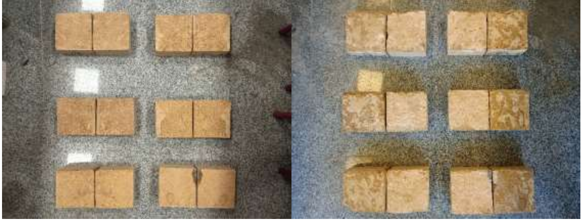
MY-3 Litik Tüf kayasında 1 mm kalınlıkta sert dolgu malzemesi-1 ile gerekleřtirilen dinamik kesme deney numunelerinin, deneyler ncesi ve sonrası grnmleri
