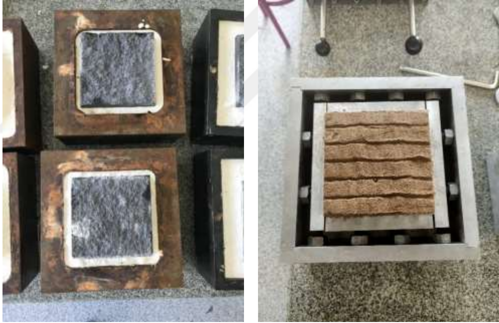
Şekil 3.25 Alçı vb. bir bağlayıcı ile sabitlenen eski numune kalıpları (solda) (Habibzadeh, 2020), ayar vidaları ve çelik destekler yardımıyla istenilen boyutta numune sabitleyebilen yeni numune kalıpları (sağda)
