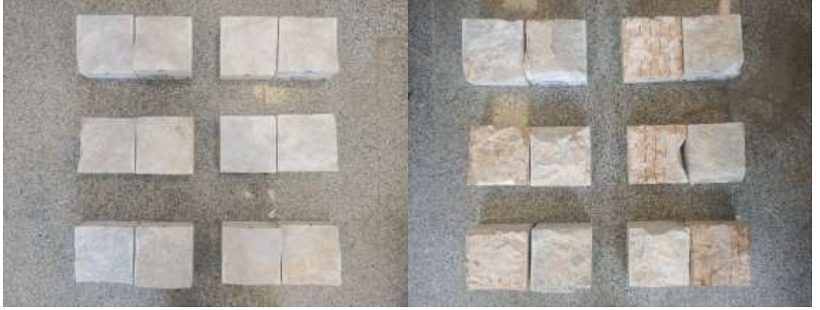
MY-2 Mermer kayasında 5 mm kalınlıkta sert dolgu malzemesi-1 ile gerekleřtirilen dinamik kesme deney numunelerinin, deneyler ncesi ve sonrası grnmleri
