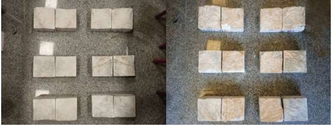
MY-2 Mermer kayasında 1 mm kalınlıkta sert dolgu malzemesi-1 ile gerekleřtirilen dinamik kesme deney numunelerinin, deneyler ncesi ve sonrası grnmleri
