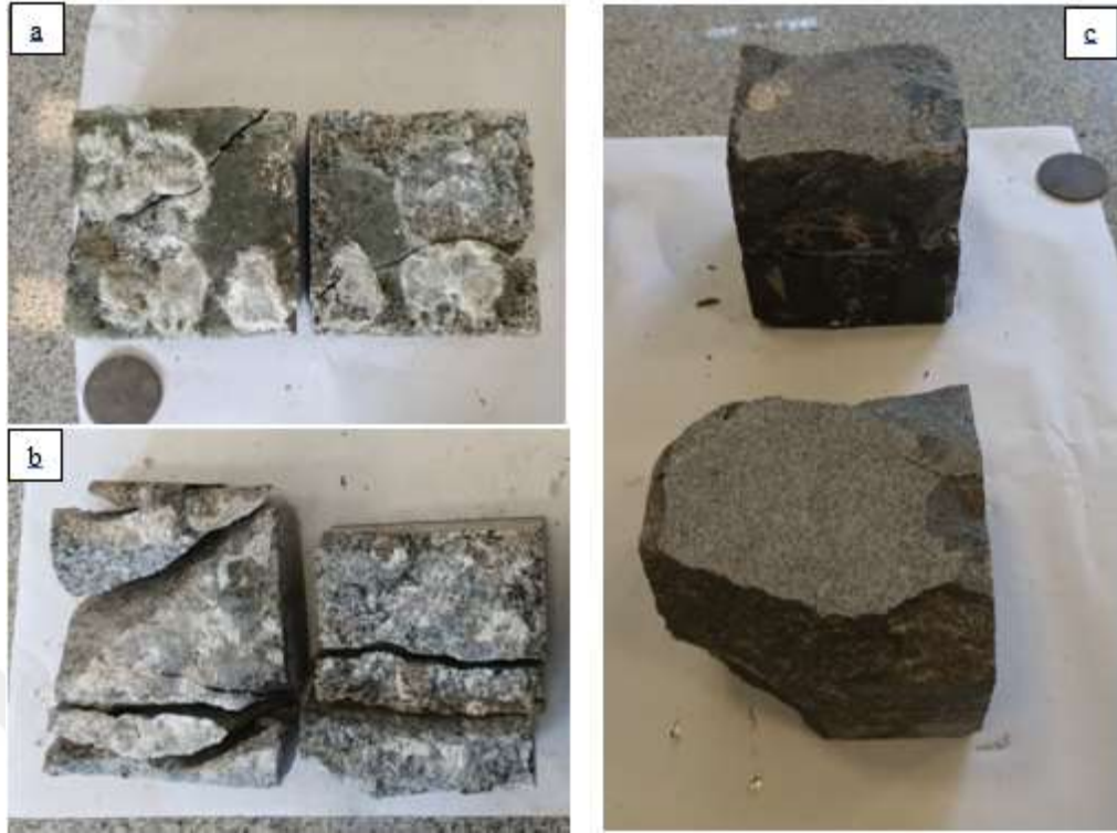
Şekil 4.11 Dinamik kesme deneylerinde kayadan büyük parça kopması (a), kayanın aşırı şekilde parçalanarak hasar görmesi (b) ve kayadan parça kopması ancak dolgu kısmının yenilmemesi (c) örnekleri
