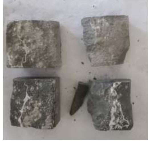
Şekil 4.2 Dolgu malzemesi dayanımının kaya dayanımını büyük oranda geçtiği dolgulu süreksizliklerde kesme yenilmesinin kayanın kendisinde gerçekleşmesinin görünümü
