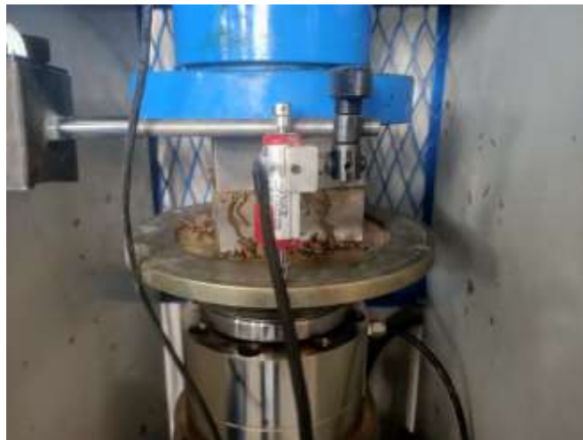
řekil 3.14 Normal gerilme altında, plastik limit su iãeriđindeki yumuřak dolgunun sũreksizlik yũzeyinden tařması
