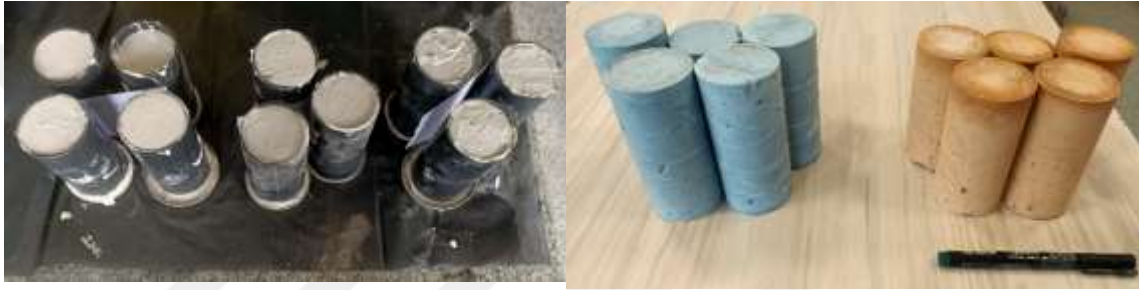
Şekil 3.2 Sert dolgu malzemelerinden silindirik numune üretimi için kullanılan kalıplar (solda), kalıplardan çıkarılan mavi Hera/Moldano ve kahverengi Hera/Moldastone CN porselen alçısı tek eksenli sıkışma dayanımı numuneleri
