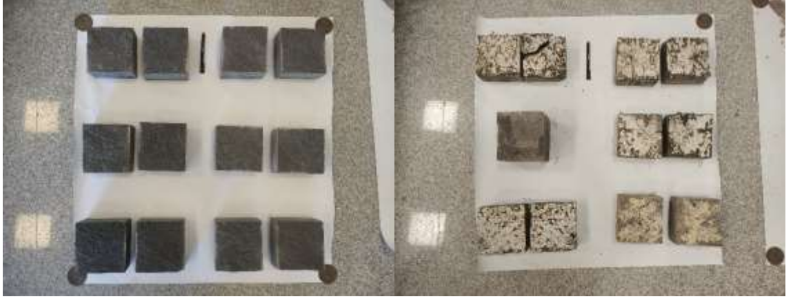
MY-1 Diyabaz kayasında 1 mm kalınlıkta sert dolgu malzemesi-2 ile gerekleřtirilen dinamik kesme deney numunelerinin, deneyler ncesi ve sonrası grnmleri
