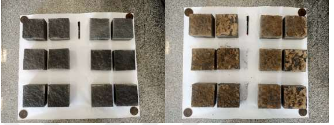
MY-1 Diyabaz kayasında 1 mm kalınlıkta yumuřak dolgu ile gerekleřtirilen dinamik kesme deney numunelerinin, deneyler ncesi ve sonrası grnmleri
