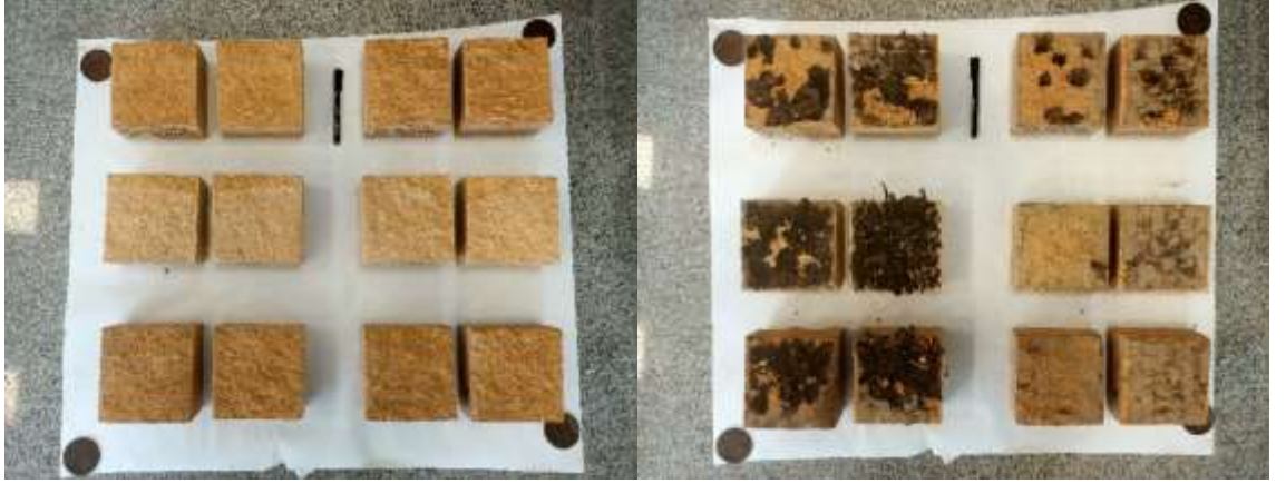
MY-3 Litik Tüf kayasında 3 mm kalınlıkta yumuşak dolgu ile gerçekleştirilen dinamik kesme deney numunelerinin, deneyler öncesi ve sonrası görünümüleri
