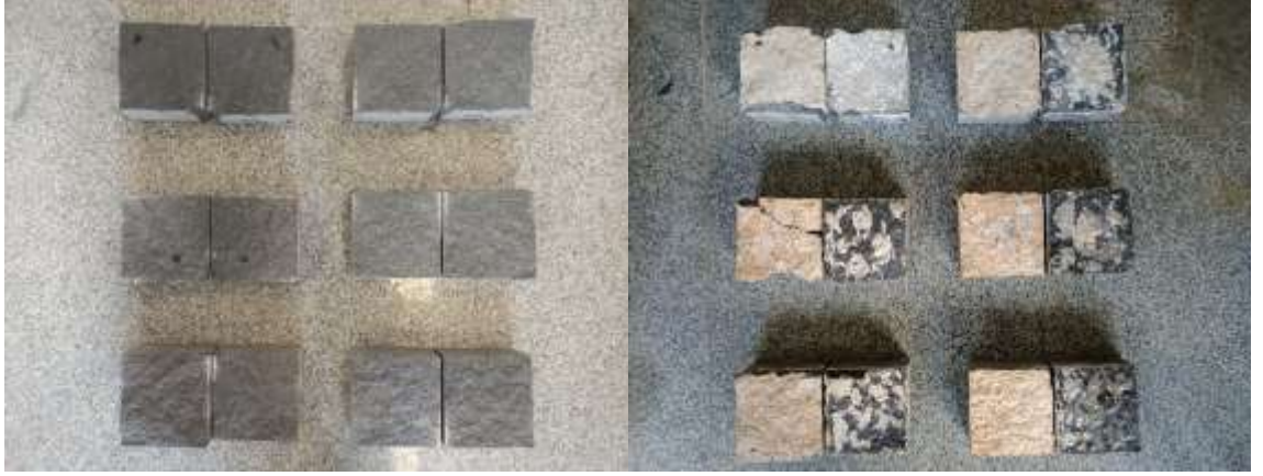
MY-1 Diyabaz kayasında 1 mm kalınlıkta sert dolgu malzemesi-1 ile gerekleřtirilen dinamik kesme deney numunelerinin, deneyler ncesi ve sonrası grnmleri
