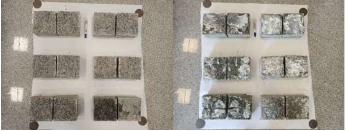
MY-6 Granodiyorit kayasında 3 mm kalınlıkta sert dolgu malzemesi-2 ile gerekleřtirilen dinamik kesme deney numunelerinin, deneyler ncesi ve sonrası grnmleri
