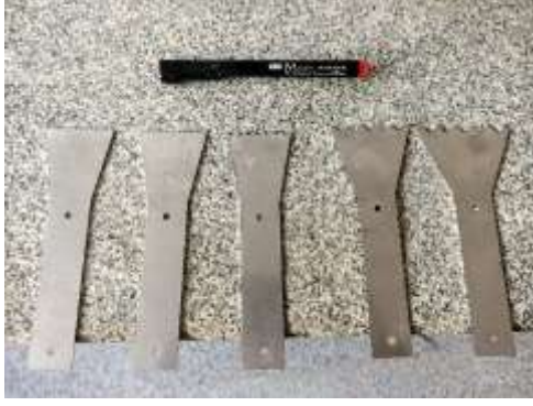
Şekil 3.18 Testere ağzı dişli yayma tarakları (solda), 4 mm dişli tarakla kalınlığı ayarlanan ve spreylene numune (sağda)
