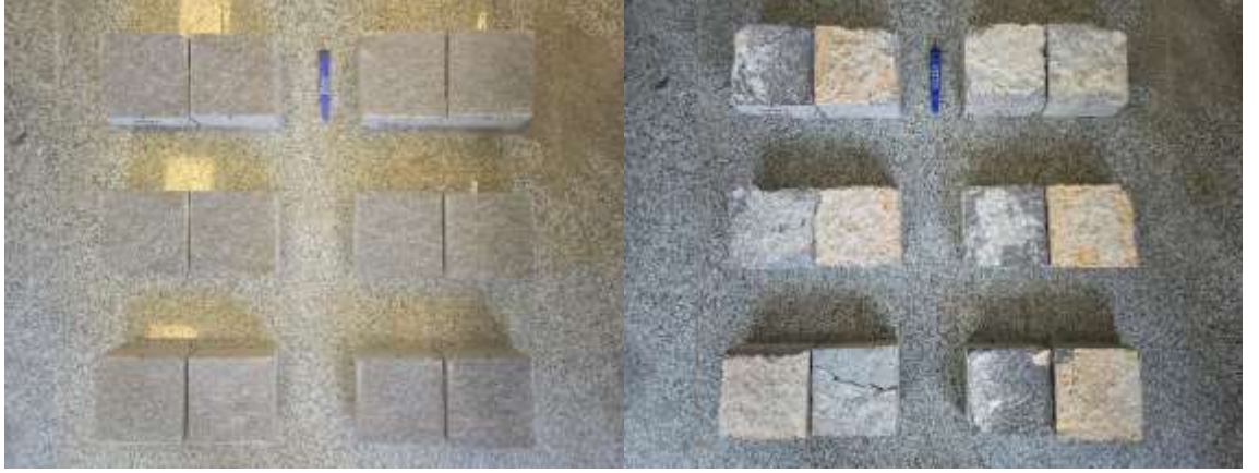
MY-5 Trakit kayasında 3 mm kalınlıkta sert dolgu malzemesi-1 ile gerekleřtirilen dinamik kesme deney numunelerinin, deneyler ncesi ve sonrası grnmleri
