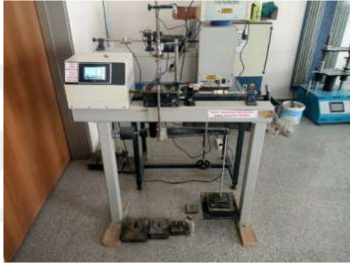
Şekil 3.5 Yumuşak dolgu malzemesinde kesme kutusu deneyi için kullanılan cihaz
