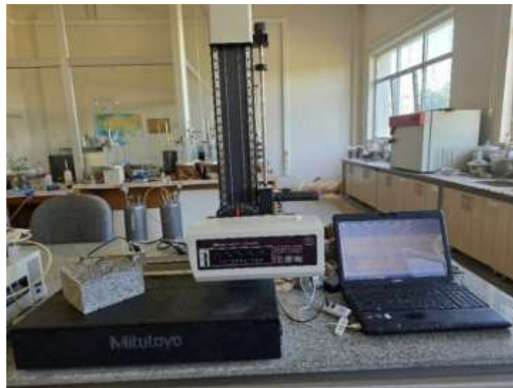
Şekil 3.9 Yapay süreksizliklerin yüzey profillerinin taranmasında kullanılan elektromekanik profilometre cihazı
