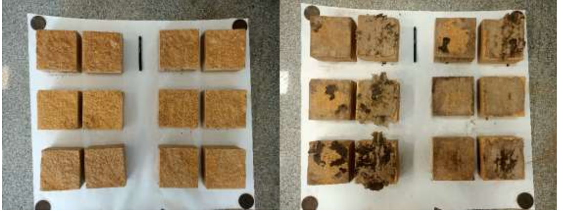
MY-3 Litik Tuf kayasında 5 mm kalınlıkta yumuřak dolgu ile gerekleřtirilen dinamik kesme deney numunelerinin, deneyler ncesi ve sonrası grnmleri
