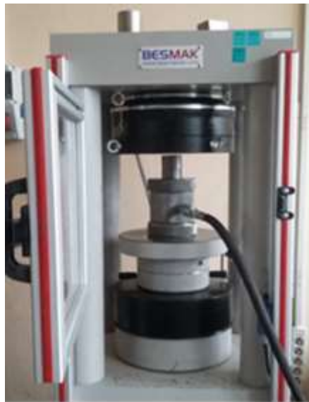
Şekil 3.6 Sert dolgu malzemelerinde üç eksenli basınç dayanımı için deney düzeneği
