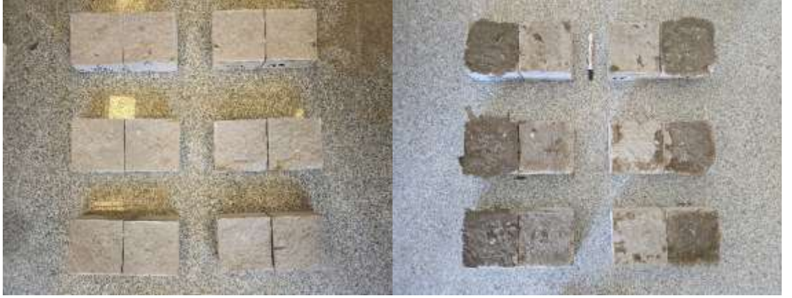
MY-4 Vitrik Tf kayasında 5 mm kalınlıkta yumuřak dolgu ile gerekleřtirilen dinamik kesme deney numunelerinin, deneyler ncesi ve sonrası grnmleri
