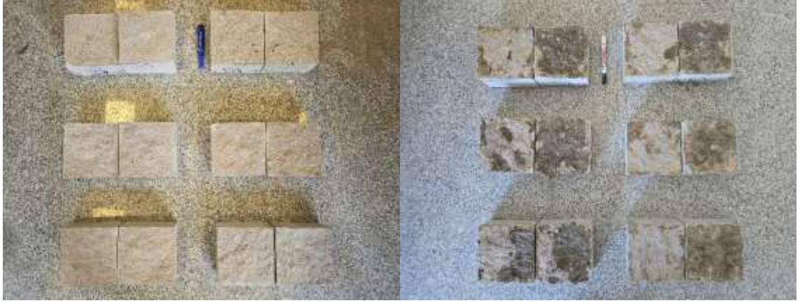
MY-4 Vitrik Tf kayasında 3 mm kalınlıkta yumuřak dolgu ile gerekleřtirilen dinamik kesme deney numunelerinin, deneyler ncesi ve sonrası grnmleri
