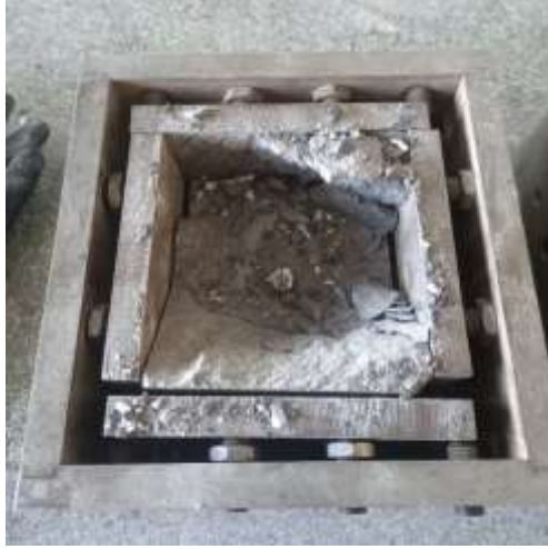
Şekil 4.2 Dolgu malzemesi dayanımının kaya dayanımını büyük oranda geçtiği dolgulu süreksizliklerde kesme yenilmesinin kayanın kendisinde gerçekleşmesinin görünümü
