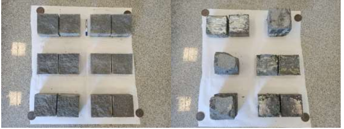
MY-1 Diyarbaz kayasında 5 mm kalınlıkta sert dolgu malzemesi-2 ile gerekleřtirilen dinamik kesme deney numunelerinin, deneyler ncesi ve sonrası grnmleri
