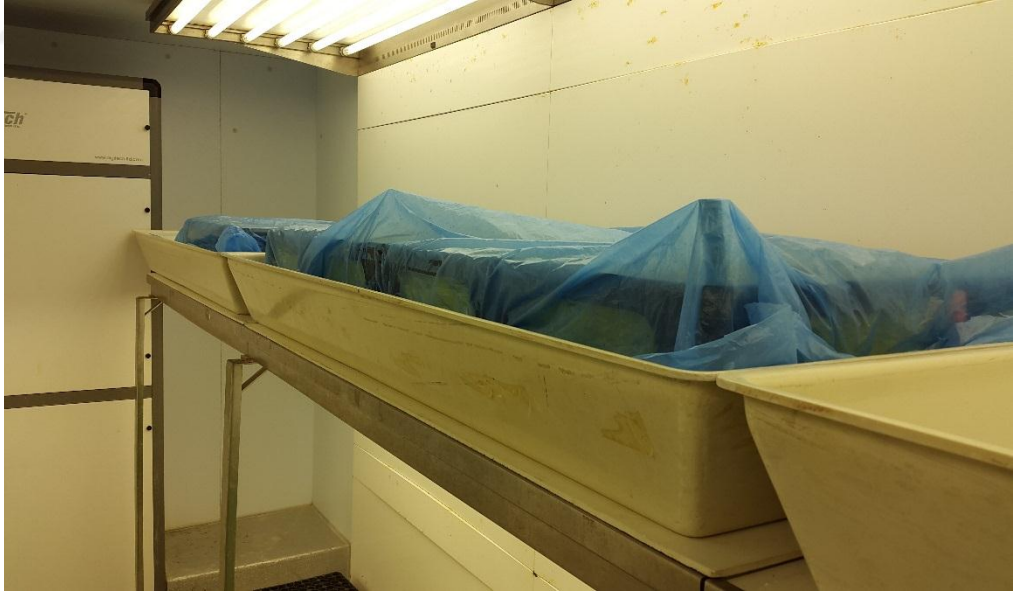
Şekil 3.9 Küvet içerisindeki kasaların bir tente ile örtülerek nemli koşullarda 48 saat boyunca inkübasyona bırakılması
