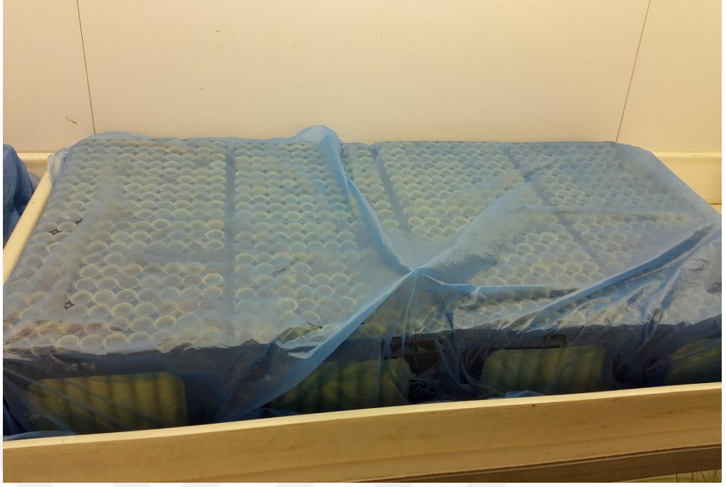
Şekil 3.8 Küvet içerisindeki kasaların bir tente ile örtülerek nemli koşullarda 48 saat boyunca inkübasyona bırakılması
