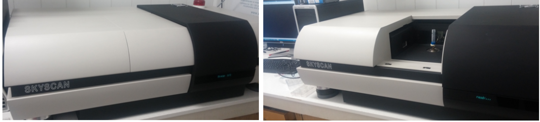
Şekil 2.7. Mikro-BT cihazı, Bruker MicroCT SkyScan 1172
