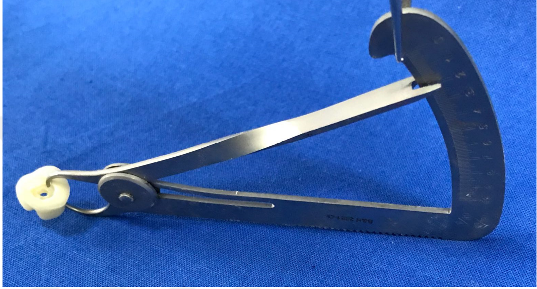
Şekil 2.2. Furkasyon alanındaki dentin sement kalınlığının kumpasla ölçülmesi
