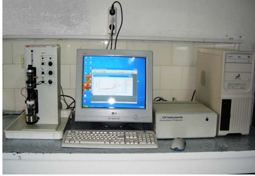
Şekil 3.1 Çalışmanın yapıldığı elektrokimyasal sistem: CH Instruments Electrochemical Workstation CHI760B ve CGME hücre standı
