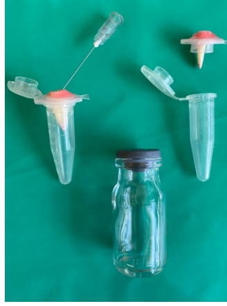
Şekil 2.4. Debris biriktirmek için hazırlanan düzenek elemanları
