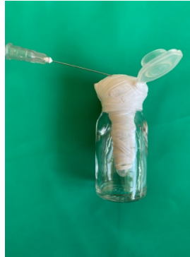
Şekil 2.5. Teflon bantla örtülmüş deney düzeneği
