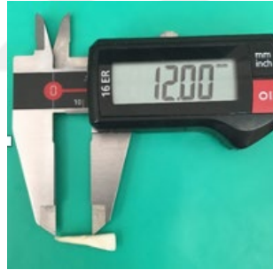
Şekil 2.2. Dişlerin digital kumpas yardımıyla ölçülmesi
