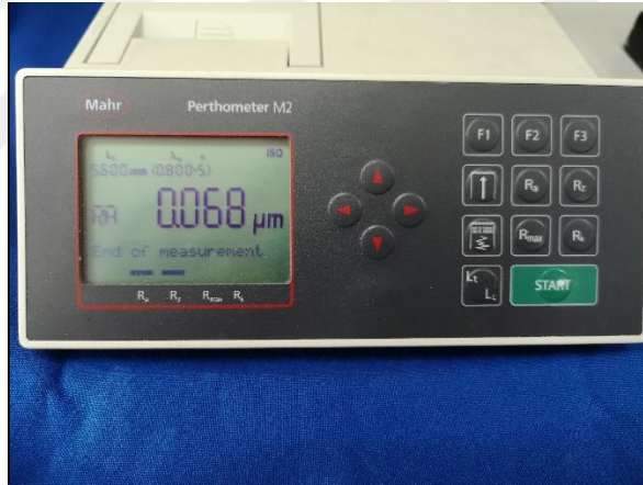
Şekil 2.8. Örneklerin yüzey pürüzlülüğünün M2 cihazında elde edilen değerleri
