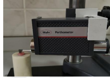
Şekil 2.7. Örneklerin yüzey pürüzlülüğü ölçümü
