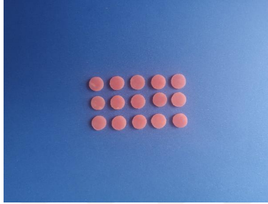
Şekil 2.4. Tesviyesi tamamlanmış akrilik örnekler
