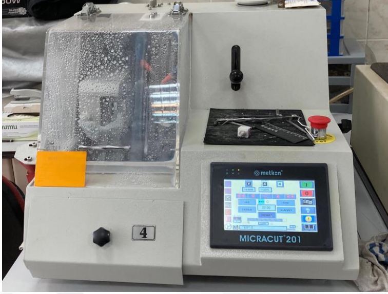
Şekil 2.1. Dişlerin kesilmesi için kullanılan su soğutmalı kesme cihazı
