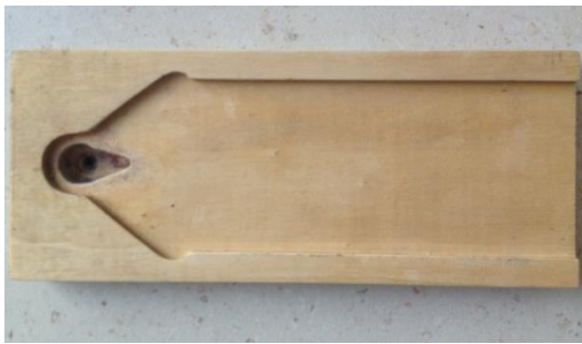
Şekil 3.1. Kolorimetre cihazının tam olarak oturabileceği ahşap blok
