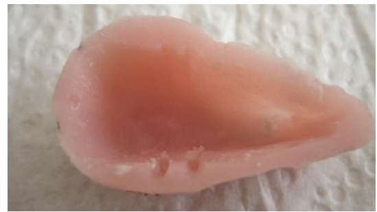
Şekil 3.2. Ahşap bloğa göre hazırlanmış içi boşaltılmış ve retansiyon olukları açılmış akrilik rezin blok
