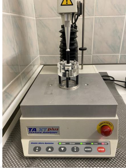
Şekil 2.5. TA.XT Plus Tekstür Analiz Cihazı ile in vitro adhezyon ölçümü
