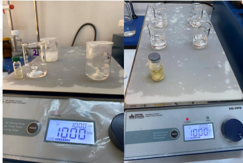
Şekil 2.2. Paroksetin yüklü kitosan-lesitin nanopartiküllerin üretimi.
