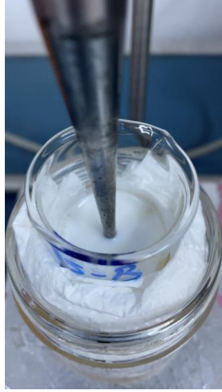
Şekil 2.4. Ultrasonik prob ile PLGA nanopartikül üretimi.
