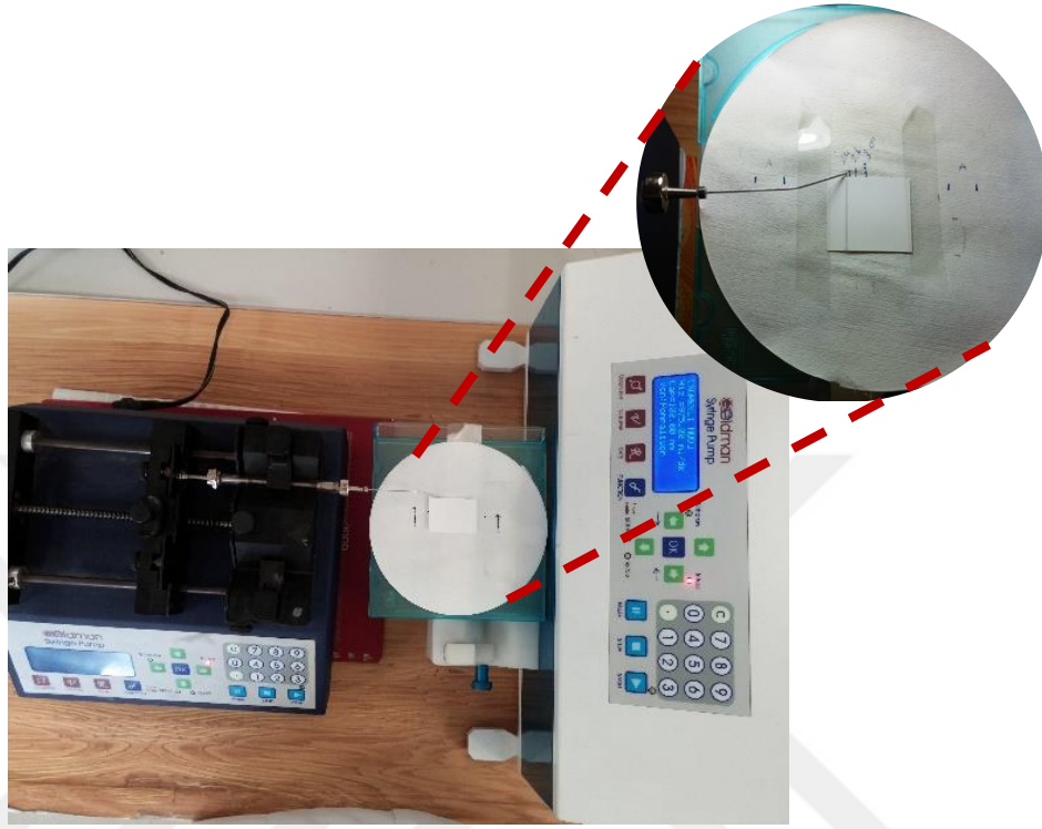
Şekil 2. 4. Şırınga pompaları kullanılarak hazırlanan mikrodispenser.
