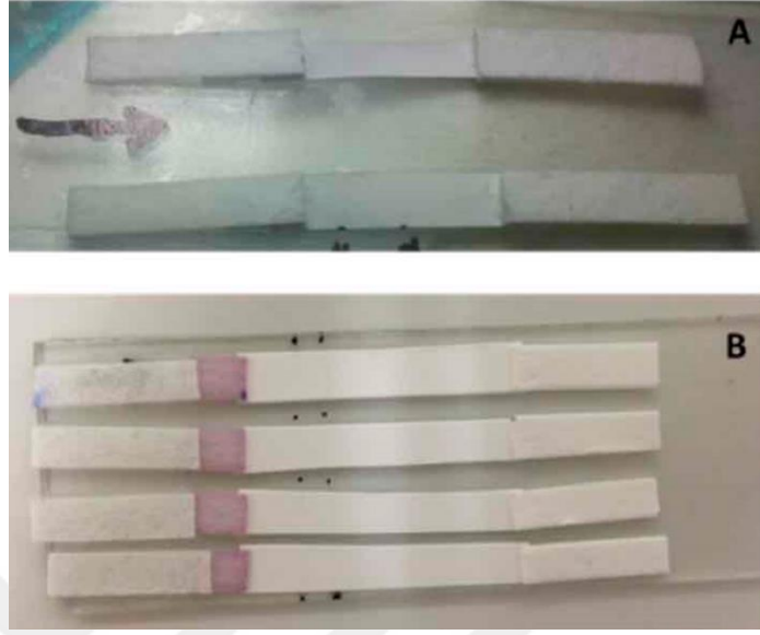
Şekil 2. 5. Hazırlanan yatay akışlı immunoassay platformlarından görüntüler: A) Konjugasyon pedi içermeyen yatay akışlı immunoassay şeridi, B) Konjugasyon pedi içeren yatay akışlı immunoassay şeridi
