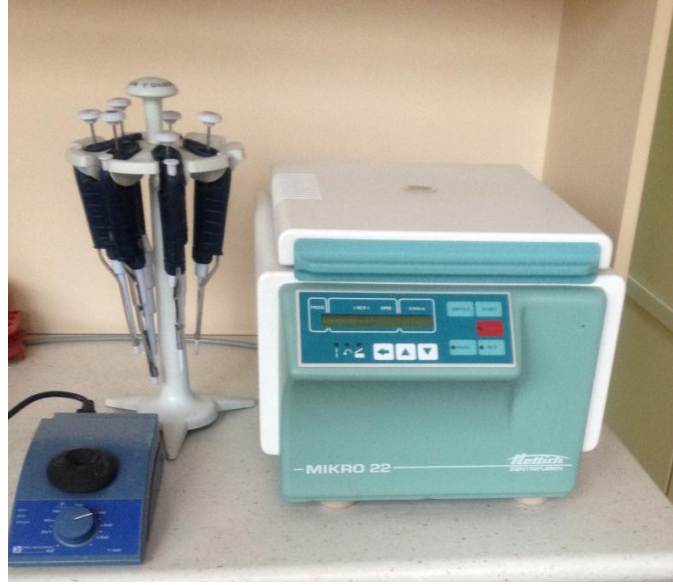
Şekil 2.4. Masaüstü Mikro Santrifüj cihazı (Mikro 22, Hettich)
