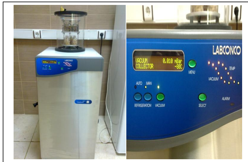
Şekil 3.4 Bitkisel materyalin liyofilizasyon işlemi
