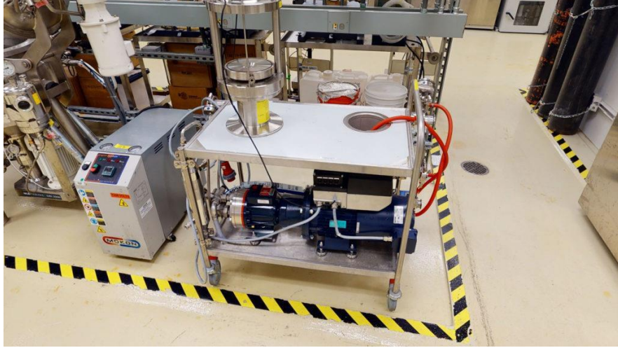
Şekil 3.3 Alfa Laval Labstak M20 membran test düzeneği
