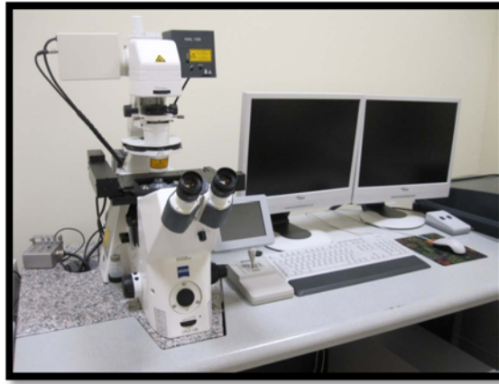
Şekil 2.14. Konfokal Lazer Tarama Mikroskobu görüntüsü
