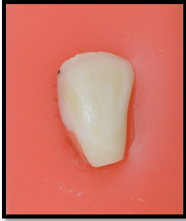
Şekil 2.1.a Köklerinden ayrılmış sığır dişlerinin kalıba gömülmüş hali
