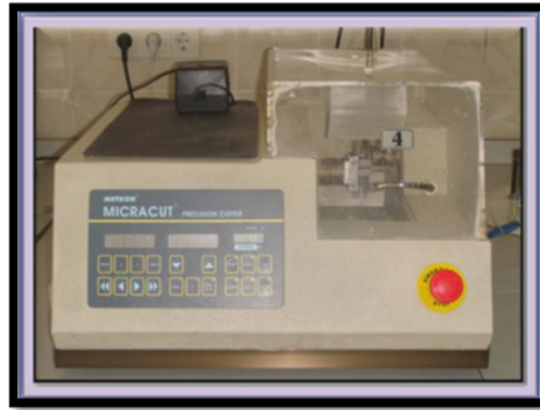
Şekil 2.1.c. Hassas Kesit Alma Cihazı
