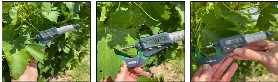
Şekil 3.13 Yaprak kalınlığı ölçümü
