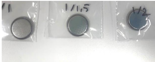
Şekil 3.13 Standart CR 2032 boyutlu düğme tipi süperkapasitör hücreleri
