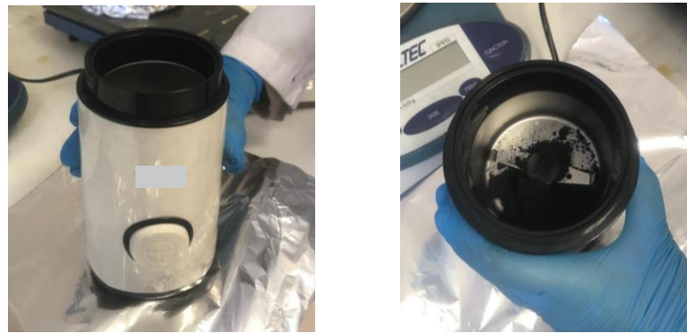
Şekil 3.5 Aktif karbon örneğine yıkama sonrasında öğütme işlemi uygulanması
