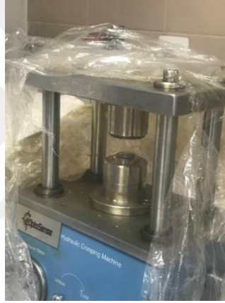
Şekil 3.12 Düğme tipi süperkapasitör hücrelerinin hidrolik presleme cihazı ile basınç uygulanarak kapatılması
