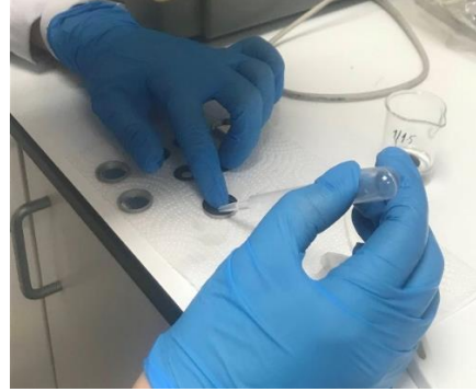
Şekil 3.11 Düğme tipi süperkapasitör hücresi hazırlanması
