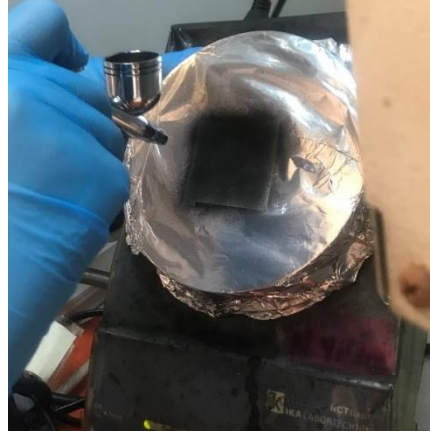
Şekil 3.9 Ni-Köpük folyonun aktif karbon içeren elektrot karışımı ile püskürtme yöntemiyle kaplanması
