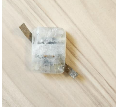
Şekil 3.15 Karbon fiber kumaşlar ile hazırlanan süperkapasitör hücresi
