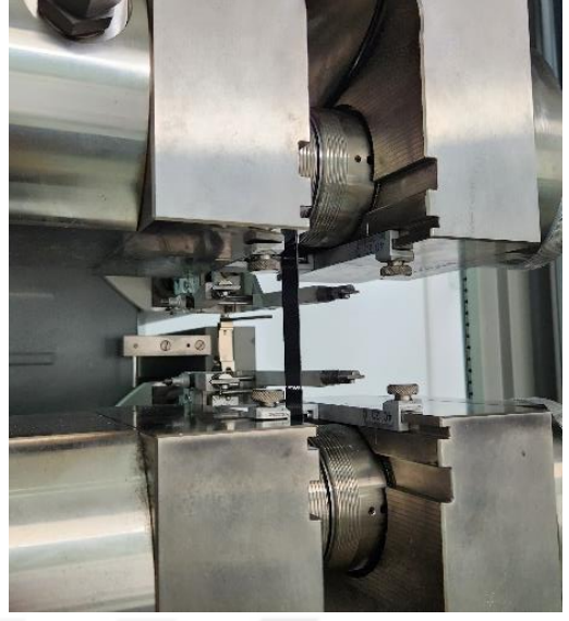
Şekil 3.21 Karbon fiber temelli kompozite çekme testi uygulanması
