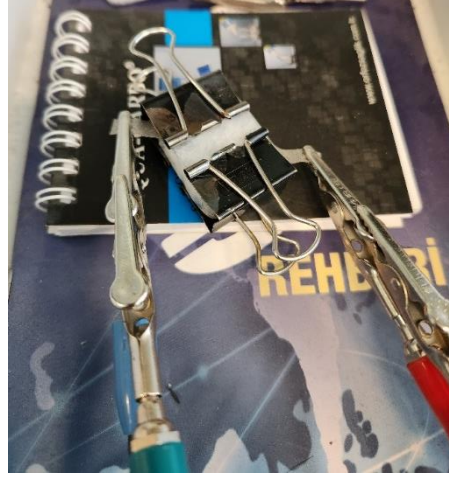
Şekil 3.16 Elektrokimyasal testleri yapılmak üzere potansiyostata bağlanmış süperkapasitör hücresi
