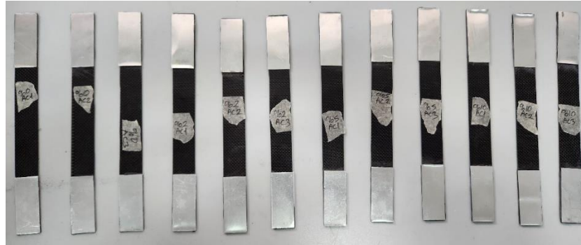
Şekil 3.20 Çekme testi için hazırlanmış karbon fiber temelli kompozitler
