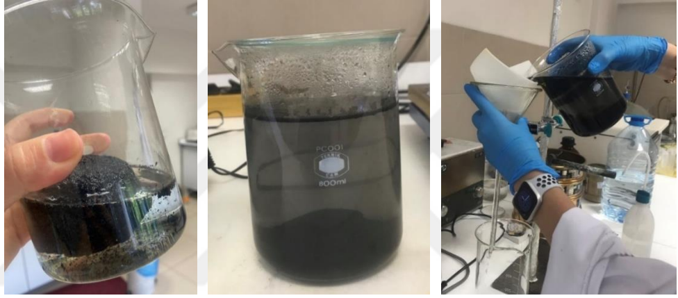
Şekil 3.4 Aktif karbon örneğine saf su ile yıkama işlemi uygulanması
