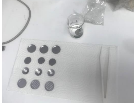
Şekil 3.11 Düğme tipi süperkapasitör hücresi hazırlanması
