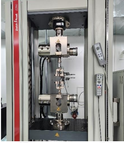
Şekil 3.21 Karbon fiber temelli kompozite çekme testi uygulanması
