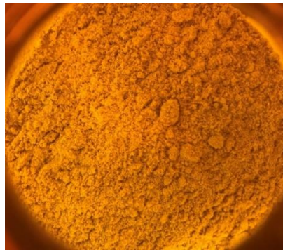
Şekil 3.2 Eleme işlemi sonucunda elde edilen biber posası (-250 \mu m)
