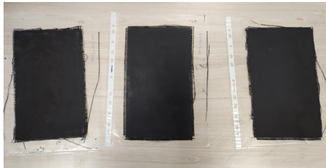
Şekil 3.18 Püskürtme yöntemi ile aktif karbon kaplanan karbon fiber kumaşlar
