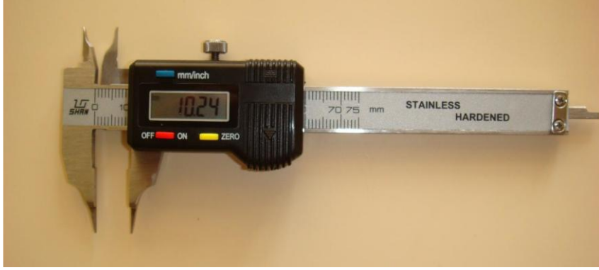
Şekil 2.13. Model ölçümü için kullanılan sayısal kumpas (Shan Digital Caliper, 0-150 mm)
