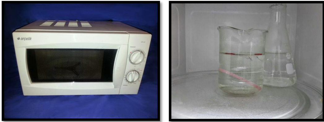
Şekil 2. 7. Mikrodalga dezenfeksiyonunun yapıldığı mikrodalga fırın ve dezenfeksiyon işleminin uygulanışı.
