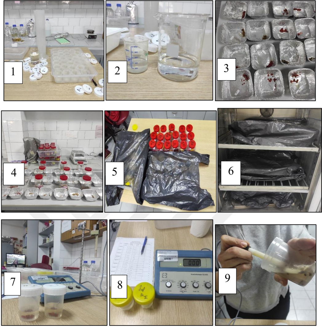
Şekil 3.12 Elektriksel iletkenlik testi ölçüm aşamala
