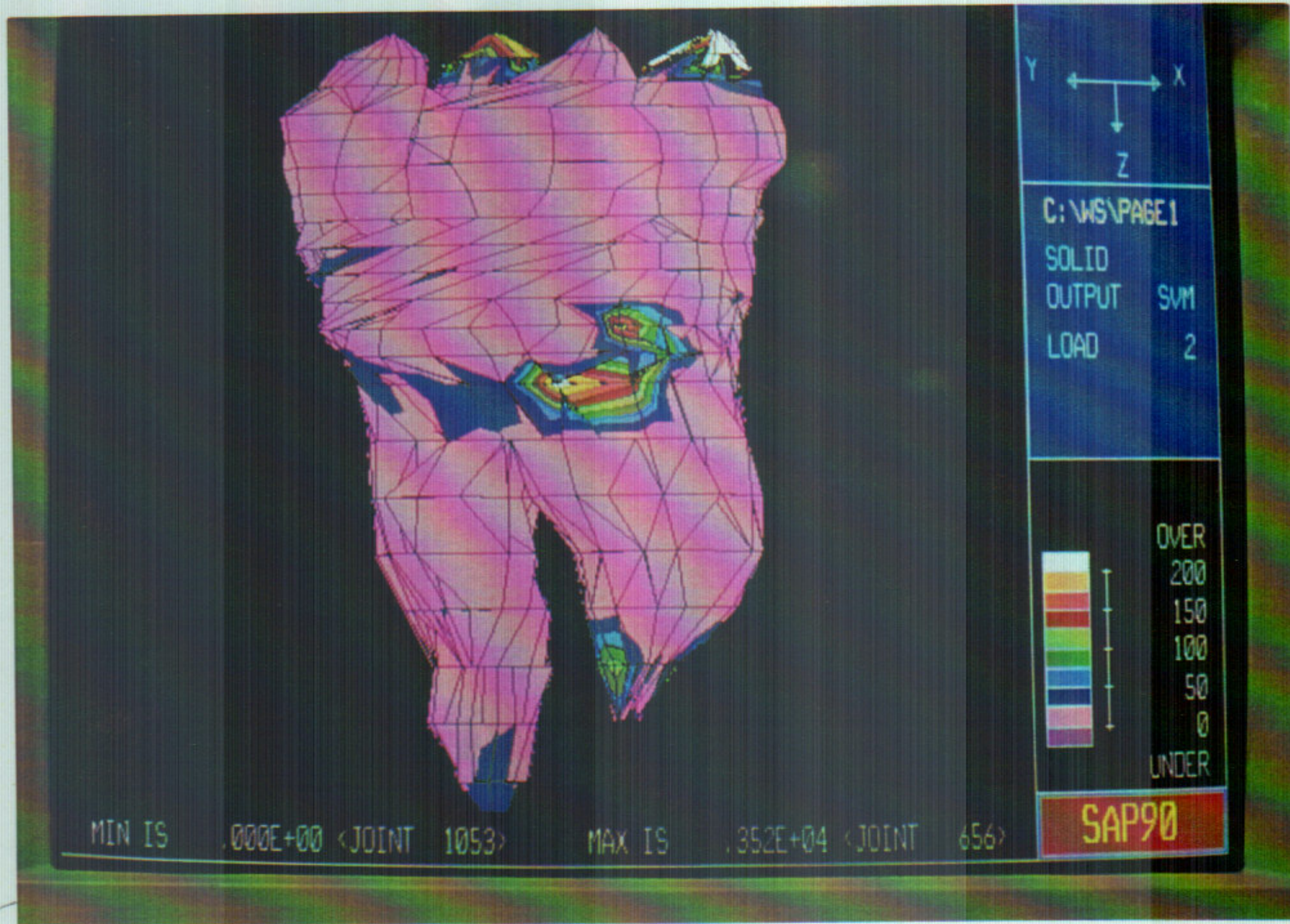
Resim 3.4; Kontrol grubunda lateral yükleme sonrası oluşan stresler
