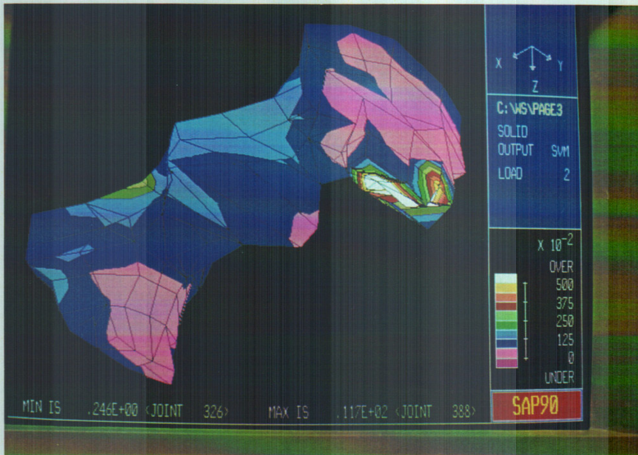
Resim 3.15; Kompozit inleyde lateral yüklem sonrası oluşan stresler
