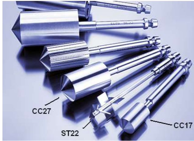
Şekil 3.3 Anton-Paar RheoLab QC cihazı ile birlikte kullanılan ve karıştırma kabının içerisine girerek dönme hareketi gerçekleştiren karıştırıcı uçlar
