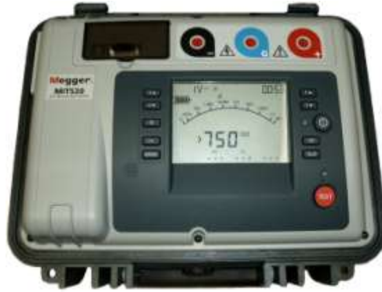
Şekil 3.6 Şeritlerin elektrik dirençlerinin ölçümünde kullanılan megaohmmetre
