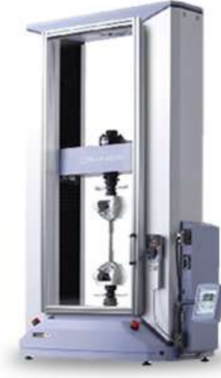
Şekil 3.7 Şeritlerin kopma mukavemetlerinin ölçümünde kullanılan çekme testi cihazı
