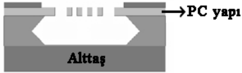
Şekil 2.14 Havada asılı fotonik kristal dilim yapının fabrike edildiğindeki şematik görünüşü (Carlsson vd. 2002)
