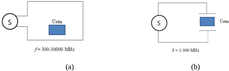
Şekil 2.5 Mikrodalga (a) ve Radyo frekans (b) ısıtma sistemlerinin şematik görünümü (Marra vd. 2009)
