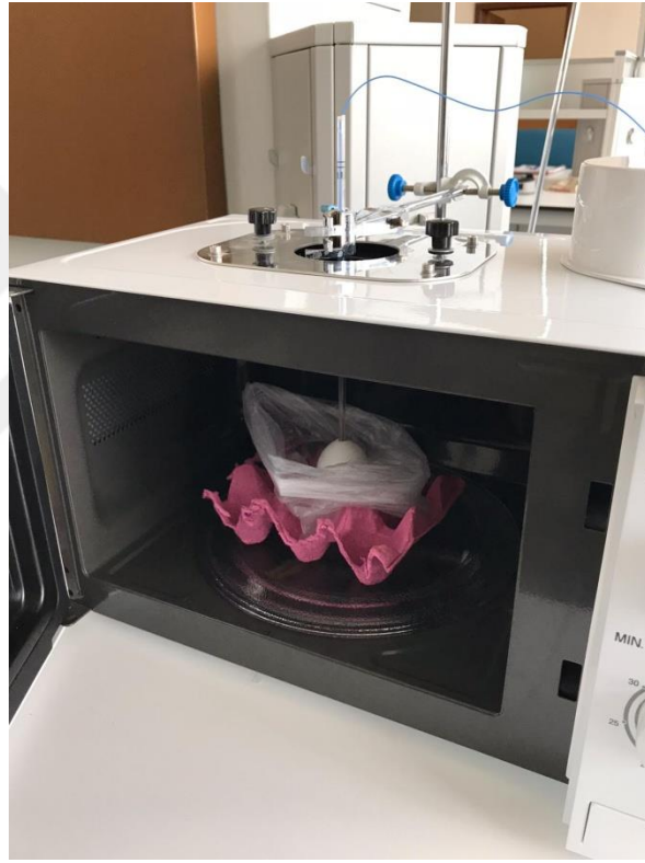
Şekil 3.2 Deneysel çalışmalarda kullanılan ev tipi LG MS2022D model mikrodalga sistem ve kullanılan deneysel sistem
