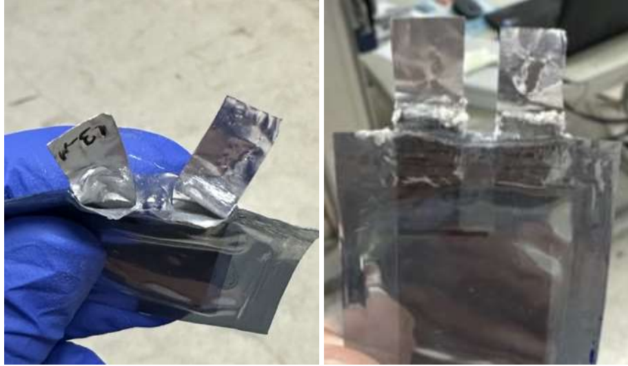
Şekil 5.94 MG-KOH-IR3 aktif karbon ve 1 M \text{Et}_4\text{NBF}_4/\text{PC} elektrolit ile hazırlanan süperkapasitörlerin GCD analizi sonrası paketi durumu, 80 °C
