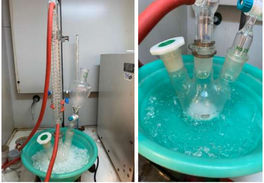
Şekil 4.7 Trietilamonyum hekzaflorofosfat sentezi deney sistemi
