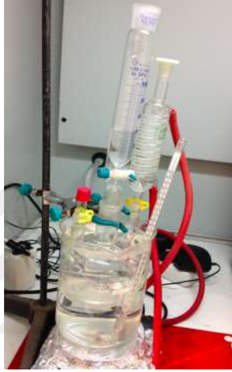
Şekil 4.5 Trietilamonyum tetrafloroborat sentezi deney sistemi
