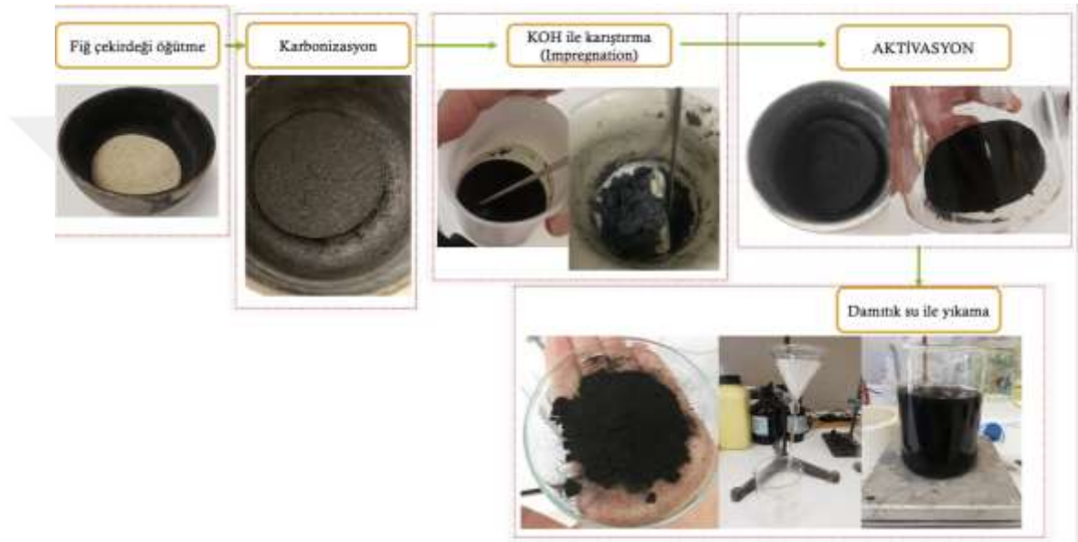
Şekil 4.1 Fiğ çekirdeğinden KOH ile aktif karbon üretimi aşamaları
