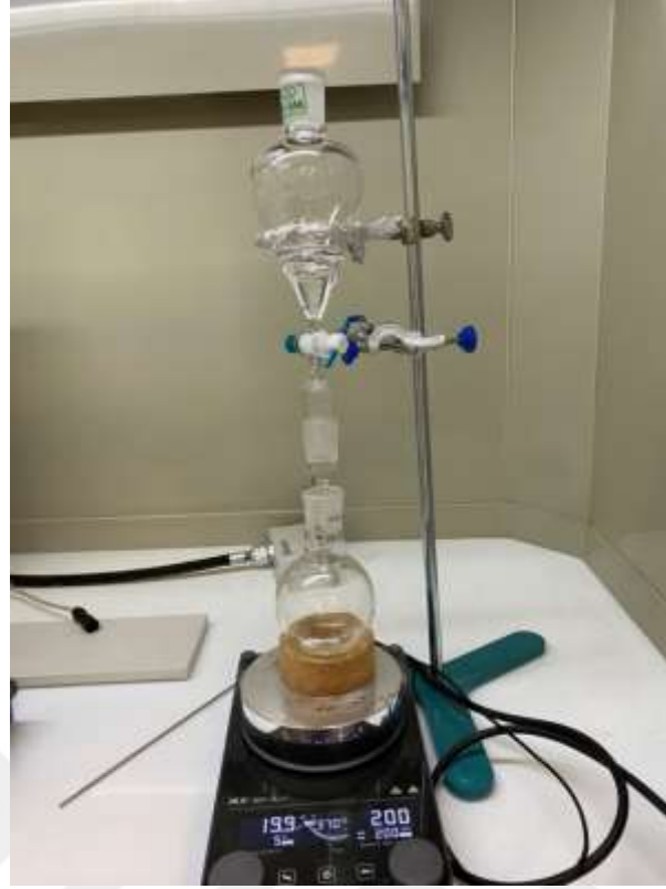
Şekil 4.6 Trietilamonyum bis(triflorometansülfonil)imid sentezi deney sistemi
