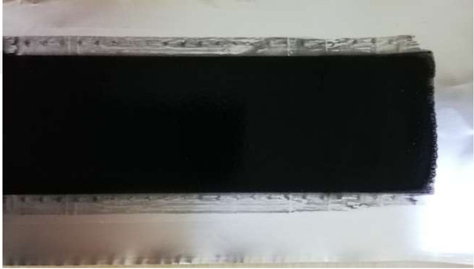
Şekil 4.3 Dr. Blade mekanizması ile üretilmiş 150 µm malzeme kalınlıklı elektrotun fotoğrafı
