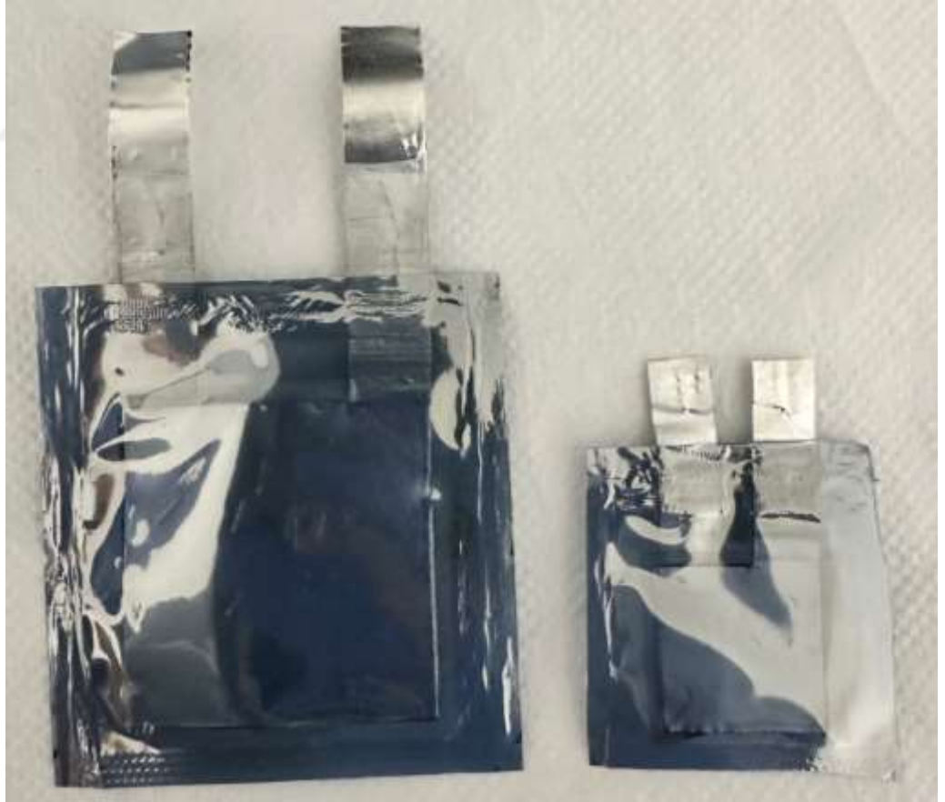
Şekil 4.9 2x2 ve 4x4 cm'lik elektrotlar ile hazırlanan paketlerin karşılaştırması
