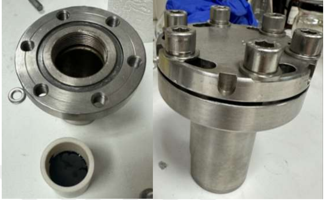
Şekil 4.2 Katkılamada kullanılan teflon beherli paslanmaz çelik reaktör
