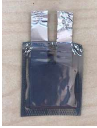
Şekil 4.8 Paketlenmiş 4 cm 2 alanlı süperkapasitörün fotoğrafı
