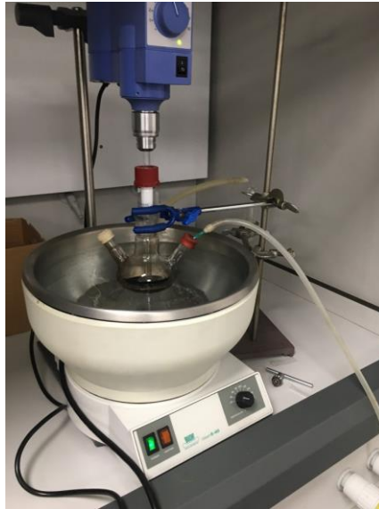
Şekil 4.4. 60^\circ\text{C} su banyosu, cam baget, üç ağızlı cam balon içeren mekanik karıştırıcı sistemi
