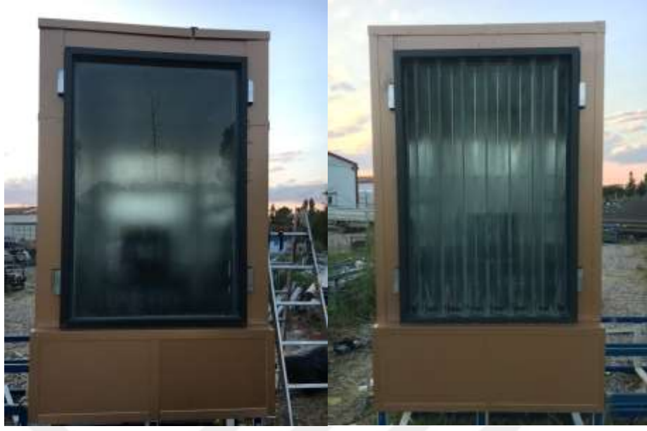
Şekil 5.12 Test kabini düz ve kırıklı cam yoğunlaşma oluşumu
