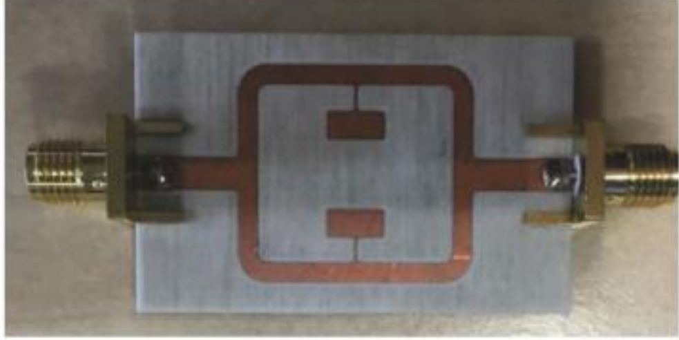
Şekil 2.19 SIR tasarımının yüklenmeden önceki hali (L.Su, 2016)
