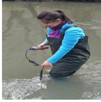
Şekil 3.9 Su parametrelerinin oksijenmetre ile ölçülmesi
